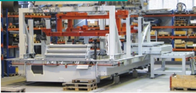
Außenaufnahme des Bauteilträgers für den Airbus; die roten Elemente stellen das Simulationsgewicht für den späteren Flugzeugrumpf dar
