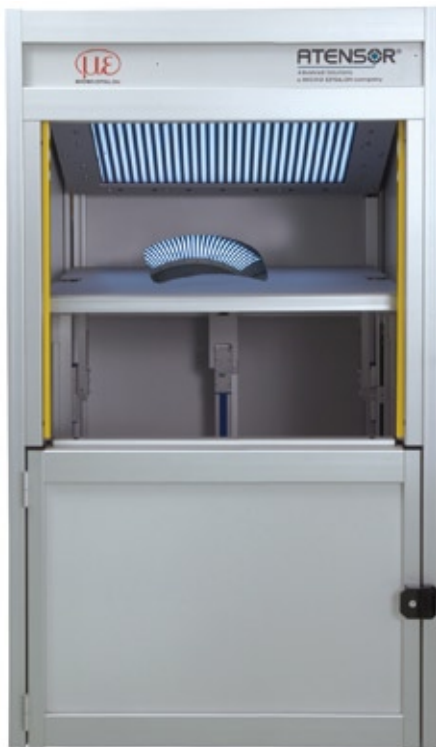
Veränderungen der Oberflächenkrümmung des Messobjekts erzeugen deutliche Verzerrungen des Streifenmusters
