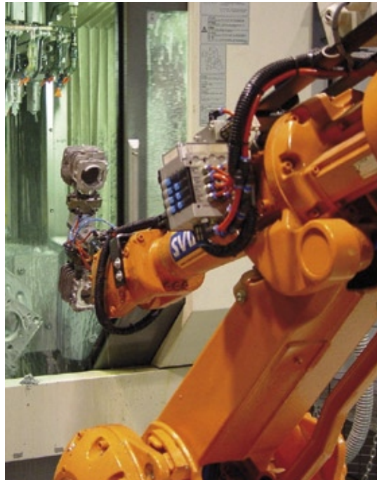
Eine Bildverarbeitung erkennt die Position und Orientierung von Zylinderköpfen für den automatischen Be- und Entladevorgang von Bearbeitungszentren
