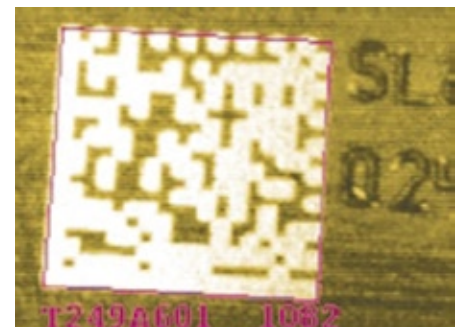
Abb. 4: Der Datacode-Leser erkennt unscharfe Codes ebenso wie Codes mit zerstörtem oder fehlendem „Finder Pattern“
