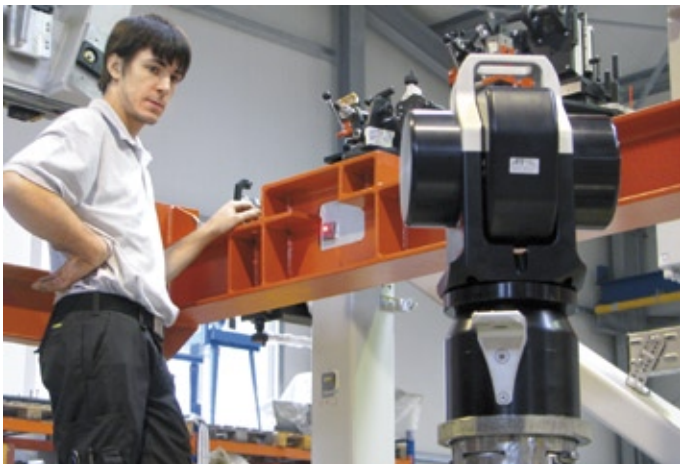
Spezielle Öffnungen innerhalb der Trägerkonstruktion, die das Gewicht des Rumpfbauteils simuliert, ermöglichen das Messen des Bauteilträgers unter realistischen Produktionsbedingungen in der späteren Flugzeugfertigung
