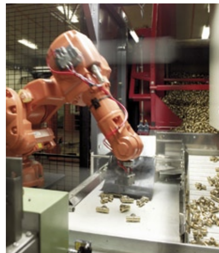
Die Bauteile werden mit dem kompakten Zuführsystem Multiflex über einen Kipper und ein Umlaufsystem einlagig unter der Kamera bereitgestellt
