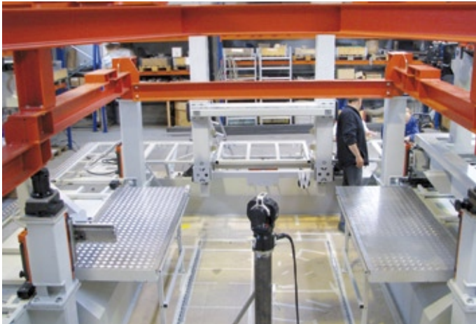
Der Laser Tracker (in der Bildmitte) dient zum Messen, Justieren und Einstellen des Bauteilträgers
