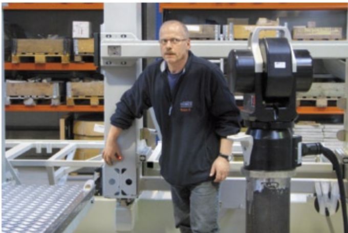
August Katteneder vermisst einen Referenzpunkt auf dem Bauteilträger
