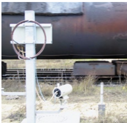
Torpedowagen befördern große Mengen flüssiges Eisen vom Hochofen zum Stahlwerk für die weitere metallurgische Behandlung. Für die Zustandsüberwachung der Feuerfestauskleidung werden zwei Infrarot-Kameras eingesetzt
