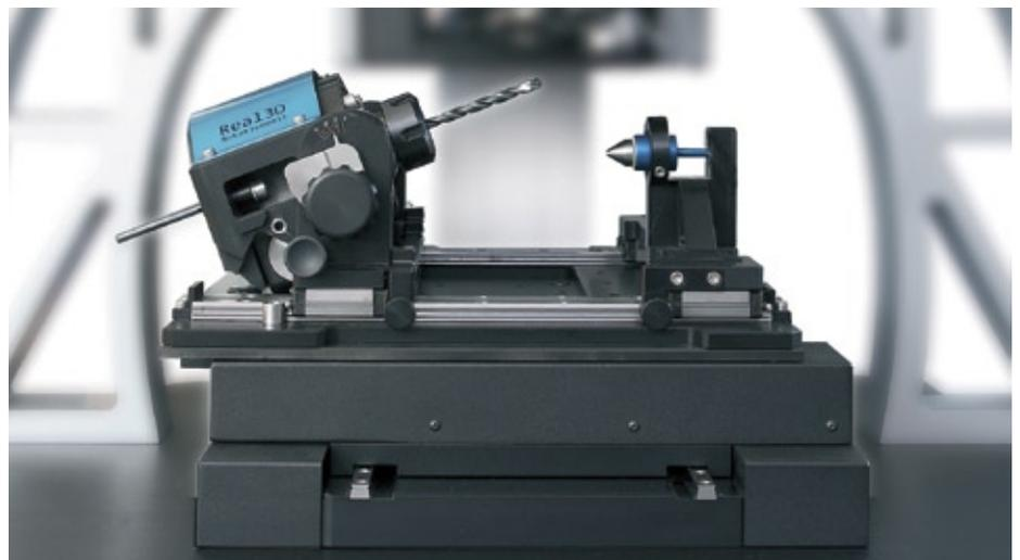
InfiniteFocus mit Rotationseinheit um Bohrer, Fräser und Gewindewerkzeuge um  $360^\circ$  zu drehen und so die Form des Werkzeugs vollständig zu messen. So misst der Anwender auch Geometrien wie die Rundheit oder den Anschnitt seiner Werkzeuge.
