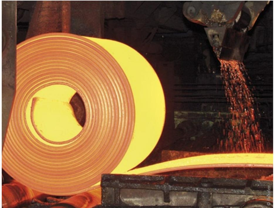
Als Messsystem kommt das System Coilcontrol des Garbsener Unternehmens Solving3D zum Einsatz. Coilcontrol ist ein berührungslos und vollautomatisch arbeitendes 3D-Messsystem mit dem der Wickelversatz an der Stirnseite des Coils mit hoher Präzision erfasst und klassifiziert wird. Selbst glühend heiße Stahlcoils mit bis zu 2 m Durchmesser werden mit einer 3D-Genauigkeit von 0,5 mm vermessen. Das System besteht aus ei-
