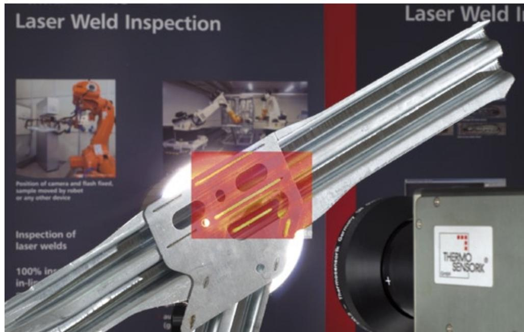
Buchstäblich blitzschnell, d.h. in weniger als einer Sekunde, durchläuft die von einem Blitz angeregte Wärmewelle das Karosseriebauteil. Gleichzeitig wird ein Infrarotvideo der gegenüberliegenden Bauteiloberfläche aufgenommen. Die Thermosensorik-Software steuert die Erfassung der Rohdaten und ihre Weiterverarbeitung zu verschiedenen Ergebnisbildern (vgl. Überblendung im Foto). Diese geben Aufschluss über die Qualität der Schweißnaht. Doch wie funktioniert dieses Verfahren?
