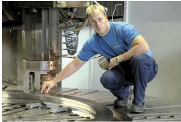
Messung direkt auf der Karusselldrehmaschine: Michael Gerards, Meister für Feinwerkmechanik, prüft mit dem Reflektor rund 30 Punkte auf dem Gussteil
