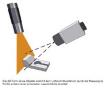
Die 3D-Form eines Objekts wird mit dem Lichtschrittbefahren durch die Messung des Phasenwinkels einer projektierten Laserstrahlens erstellt.
