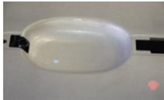
Abb. 4: Bei der Oberflächeninspektion im Fertigungsprozess werden Fehlerstellen optisch markiert
