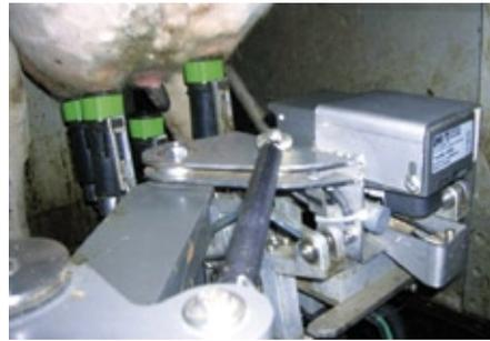
**Durch seine kompakte Bauform und sein geringes Gewicht erlaubt der TOF-Sensor eine direkte Montage am Roboterarm**
