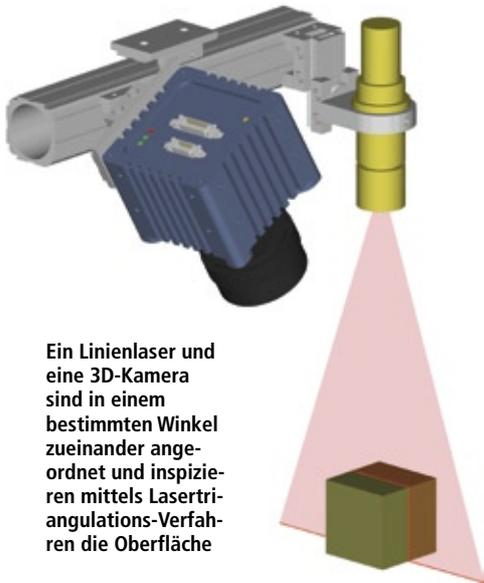
Ein Linienlaser und eine 3D-Kamera sind in einem bestimmten Winkel zueinander angeordnet und inspizieren mittels Lasertriangulations-Verfahren die Oberfläche
