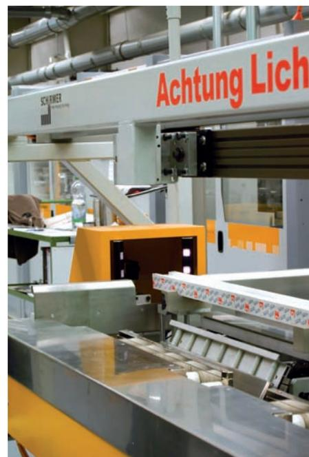
Das In-Sight Micro 1100 von Cognex prüft, ob das manuell aufgelegte Fensterrahmen-Vierkantrohr zur Systemvorgabe der EDV passt
