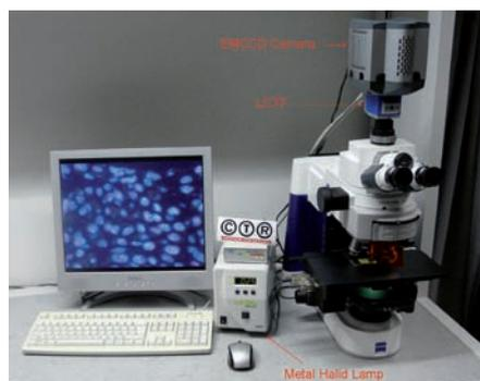
Der Systemaufbau mit Kamera, Lichtquelle, Filter und Visualisierung
