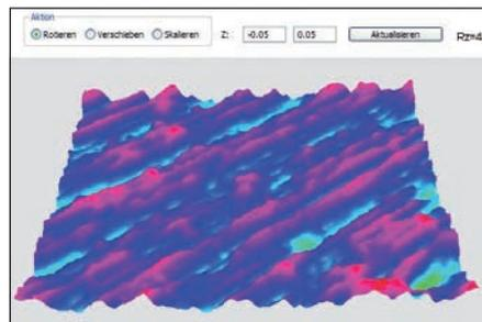
Abb. 4: Mit Shape-from-Shading-Verfahren können die Oberflächenrauigkeit und die Vorzugsrichtung der Riefen auf einfache und schnelle Weise ermittelt werden.
