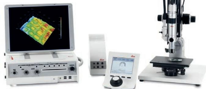
Zusätzlich verfügt Leica über eine **Nanotechnologie für kontaktfreie 3D Oberflächenmessungen**. Das Dual-Core 3D-Messmikroskop Leica DCM 3D verbindet Konfokal-Mikroskopie, Interferometrie und Farbbildgebung in einem Sensorkopf. Das Gerät wertet Mikro- und Nanogeometrien von Werkstoffoberflächen sekundenschnell, kontaktfrei und bis auf 0,1 nm genau aus.
