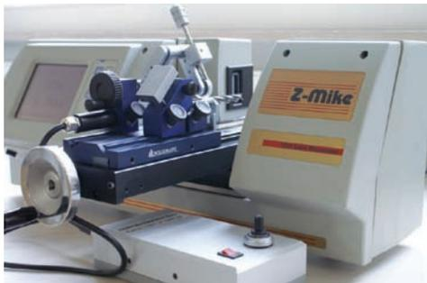
Das Lasermikrometer unterliegt keinem Temperatureinfluss und wird somit problemlos fertigungsbegleitend eingesetzt.
