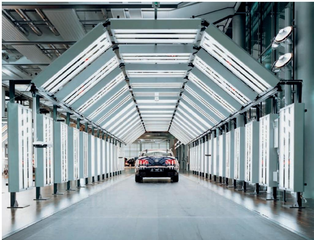
mäßigkeiten mit Abweichungen ab einer Größe von 10 µ werden so stark verdeutlicht, dass sie im laufenden Prozess für das menschliche Auge sichtbar werden. Das Unternehmen Uwe Braun hat sich im Bereich der Automobilindustrie mit Lichttunneln und ColorMatching-Kabinen einen Namen gemacht. Letztere dient dazu, Farbabweichungen von Einzel- und Zulieferteilen durch Simulation von verschiedenen Tageslichtsituationen erkennbar zu machen.
