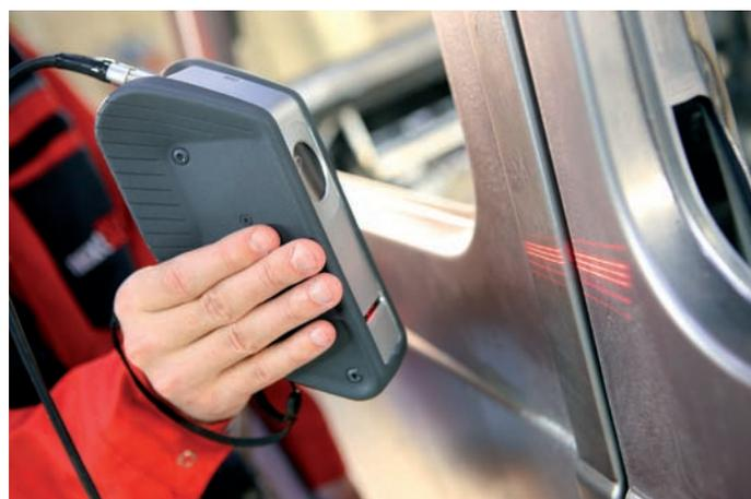
Der Kippwinkel des Messgeräts zur Oberfläche wird über ein patentiertes Verfahren erkannt und damit das Messergebnis korrigiert, eine genaue Ausrichtung des Handsensors ist für die Messung damit nicht notwendig
