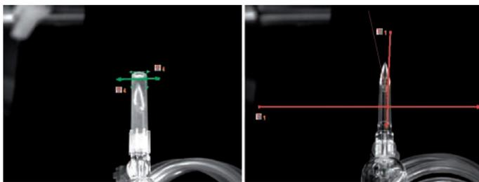
Der Durchmesser der Schutzkappe aus transparentem Kunststoff kann mit der Baumer FEX-Technologie stabil ausgewertet werden
