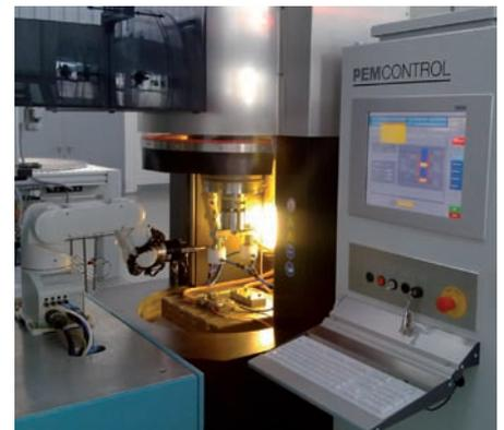
Roboter bei Teileentnahme
