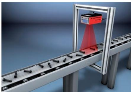
Der Leuze LSIS 412 Bildverarbeitungssensor kann beispielsweise zur Sortierung von Schrauben eingesetzt werden (Quelle: Leuze electronic)
