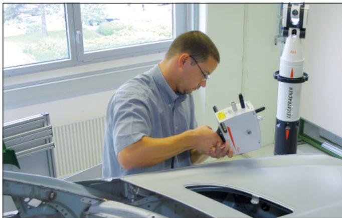
Messtechniker Dirk Noffke überprüft den Spalt zwischen dem linken Kotflügel und der Motorhaube
