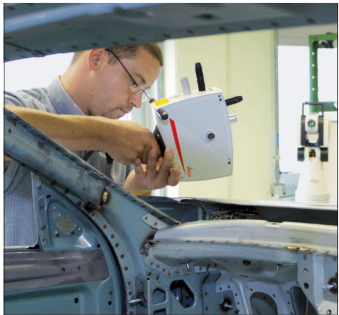
Aufgrund des großen Messvolumens des Leica T-Probe/T-Scan Systems, das die Prüfung von Objekten in einem Bereich von 15 m erlaubt, kann eine ganze Seite der Rohkarosse ohne Umpositionierung des Leica Laser Trackers gemessen werden
