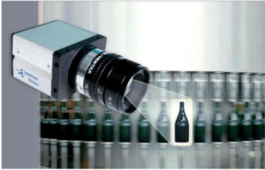
Aus seiner modularen Kameraserie PicSight stellt Leutron Vision zwei Megapixel-Modelle mit der ungewöhnlichen Sensorgröße von 1 / 2,7-Zoll vor. Die 1 Megapixel CCD-Farbkamera PicSight-P133B liefert zehn Bilder/Sekunde (fps) bei einer Auflösung von 1.308 x 779 Bildpunkten und quadratischer Pixelgröße von
