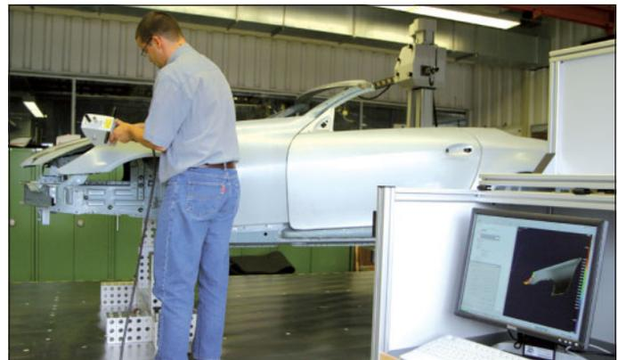
Dirk Noffke, Messtechniker bei DaimlerChrysler in Bremen, überprüft die Maßhaltigkeit des linken Kotflügels einer Mercedes SLK Rohkarosserie: der Abgleich zwischen Mess- und CAD-Daten wird mit der PolyWorks Inspector Software in Echtzeit auf einem Anwendungs-PC durchgeführt
