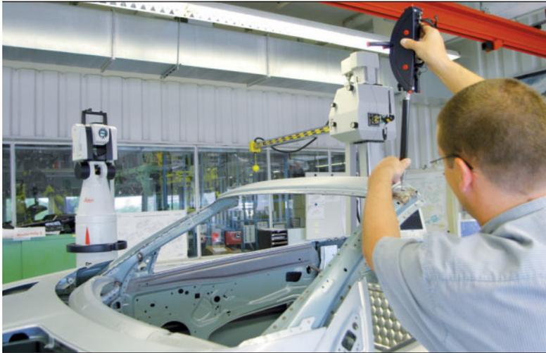
Ein Leica LTD840 Laser Tracker verfolgt die Position der Leica T-Probe an den Bezugsbohrungen in der A-Säule, dabei dokumentiert er nicht nur die 3D-Koordinaten des handgeführten Tasters, sondern auch dessen Nick-, Roll- und Gierwinkel
