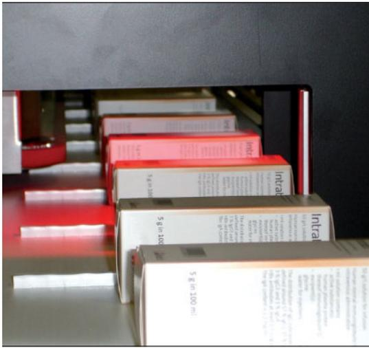
Da die Verpackungen permanent in Bewegung sind werden von VMT in dieser Anlage Full Frame Shutter-Kameras eingesetzt
