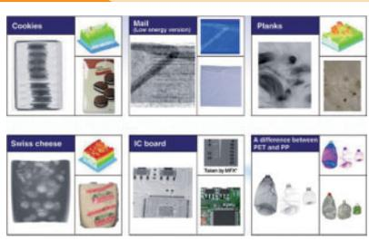
CCD TDI Sensoren und gestatten es, sehr hohe Scan-Geschwindigkeiten (>100 MHz) zu erzielen. Die hohe Empfindlichkeit dieser Sensoren im UV- und nahen IR-Bereich erschließt neue Anwendungen z. B. im Bereich der Materialsortierung.
