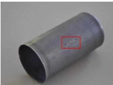
Fertiges Gehäuse mit Fehlern
