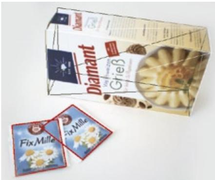
Abb. 2: Erkennung und Lokalisierung verschiedener Objekte. Für 3D-Objekte kann mithilfe der Keyetech 3D Extension die 6-DoF Lage bestehend aus Rotation und Translation bestimmt werden.
