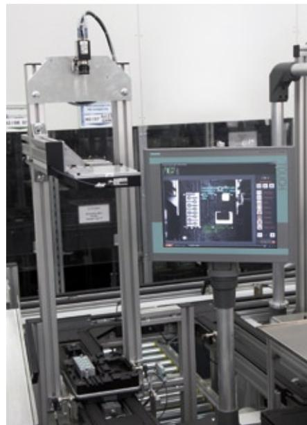
Bayreuth. Die Software läuft auf dem Simatic S7-mEC. Hochauflösende Kameras liefern die Aufnahmen dazu. Flächenblitzleuchten garantieren eine über lange Zeit exakt reproduzierbare Ausleuchtung und schließen den Einfluss von Fremdlicht aus. Das Blitzlicht ist exakt ausgerichtet und wird außerhalb des Prüfereichs nicht wahrgenommen.
