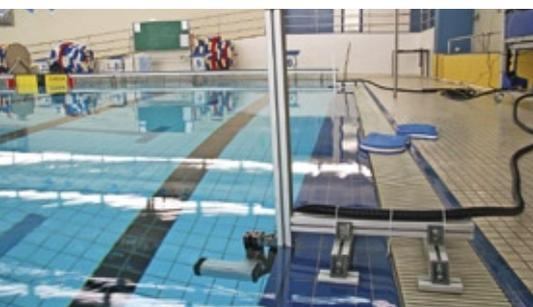
▲ Starten und Wenden im Überblick: Die Start-, Eintauch- und erste Unterwasserphase werden synchron mit einer Über- und einer Unterwasserkamera aufgenommen. Die weiteren Abschnitte werden jeweils mit einer Einzelkamera verfolgt.
