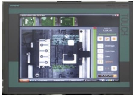
Die Bedienoberfläche der Bildverarbeitungs-Software Simavis P auf dem Panel Monitor Pro gibt an, ob alle Prüfkriterien erfüllt sind
