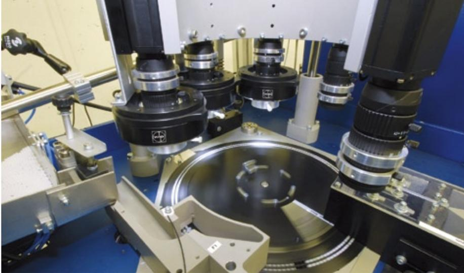
Prüfsystem zur Oberflächen- und Maßkontrolle von Glas-, Kunststoff- und Metallkugeln, Kamerasysteme inspizieren dabei die Oberflächen
