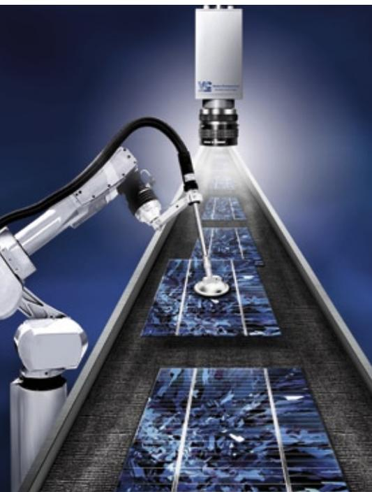
◀ Wafer-Positionierung mit der VC Solar Solution
