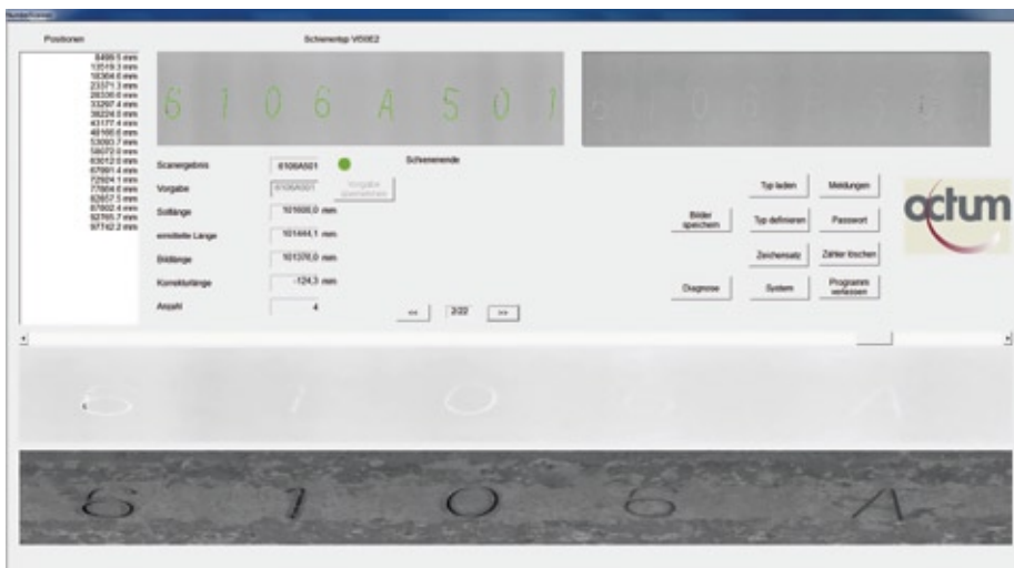
Anzeige im Automatikbetrieb mit Darstellung der 3D- und Helligkeitsdaten der Codierung, Position der Zeichenblöcke auf der Schiene.
