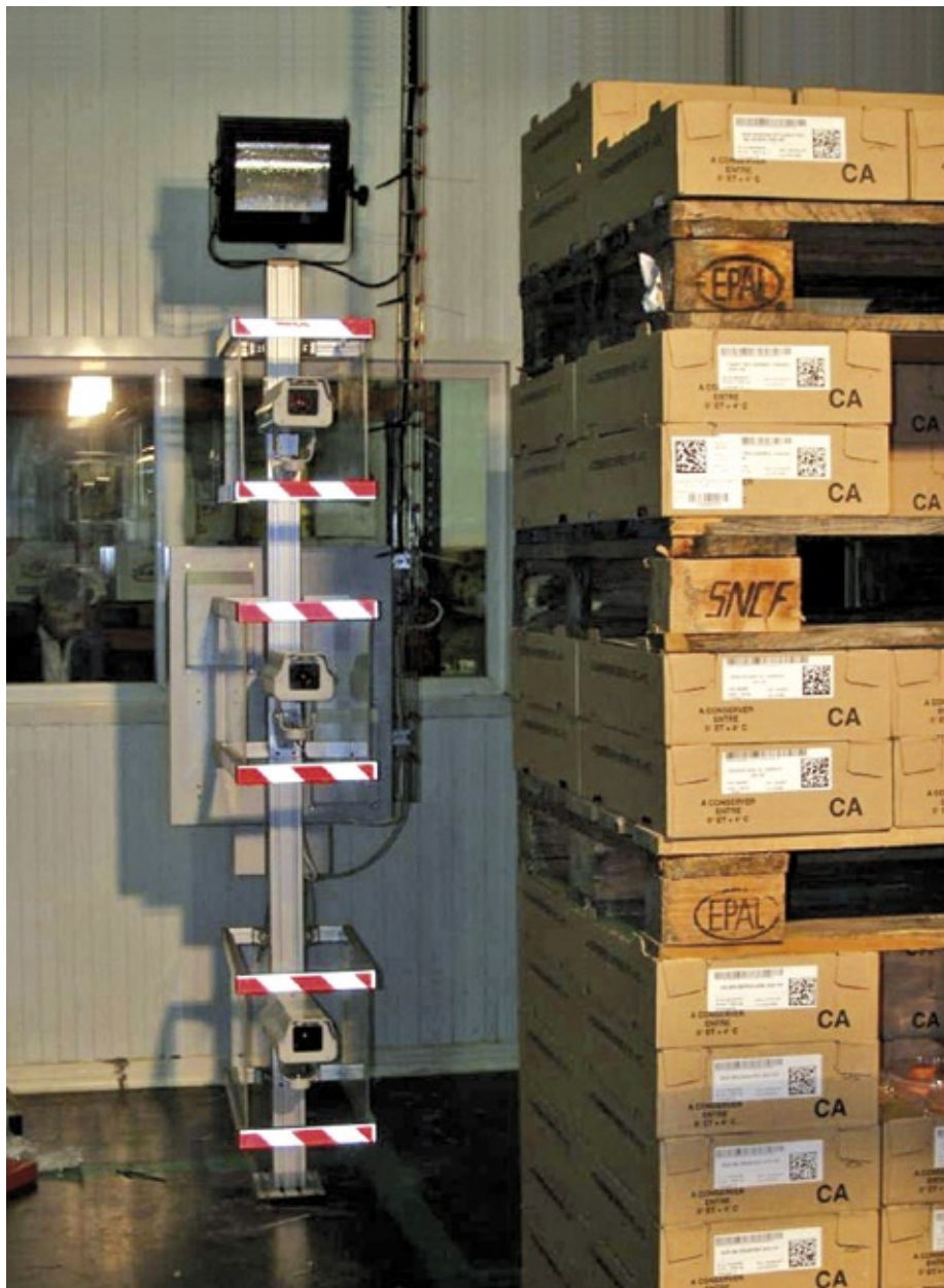
In hochauflösenden Bildern werden komplette Versandpaletten über 1D- und 2D-Barcodes in Sekundenschnelle erkannt und decodiert.
