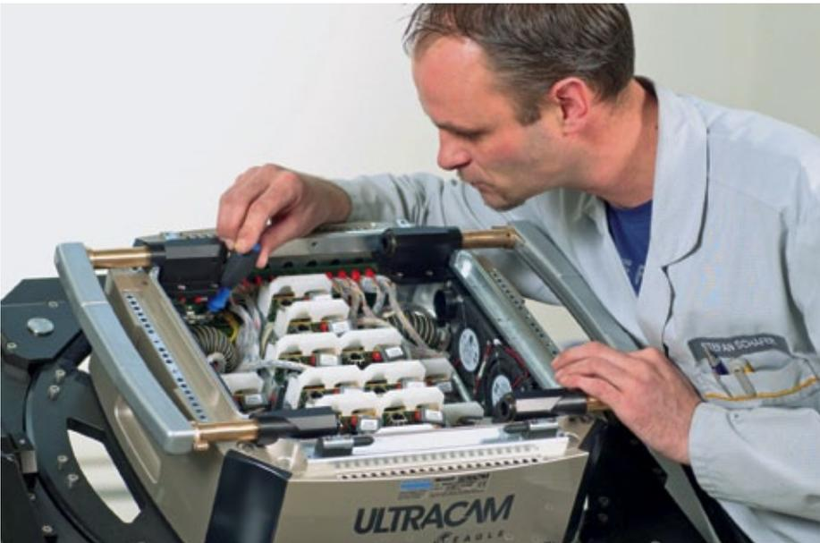
Die Speichereinheit (Solid State Drive) und die Rechereinheit sind auf engstem Raum im Sensorkopf integriert. Dadurch kann das Gesamtgewicht und der Platzbedarf halbiert werden. Foto: Wild GmbH
