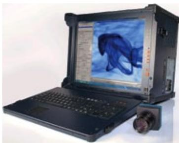
Mikrotron liefert mit dem neuen Motionblitz LTR2 Portable (Long Time Recording) ein Hochgeschwindigkeits-Videosystem für Langzeit-Aufnahmen. Anwendungsfälle sind beispielsweise die Beobachtung des Verhaltens von Turbulenzen in Flüssigkeiten und Gasen, von Feinstäuben im Vakuum, Beobachtungen in der medizinischen Diagnostik und
