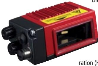
Die neue Baureihe modularer Barcodeleser BCL 300i von Leuze electronic wurde um eine Gerätevariante mit integrierter Profinet-Schnittstelle erweitert. Der damit ausgestattete Barcodeleser BCL 348i kann somit direkt, also ohne zusätzliche Software, in das Profinet-Netzwerk eingebunden und über die Hardware-Konfiguration (HW-Config) parametrierbar werden. Zusätzlich kann
