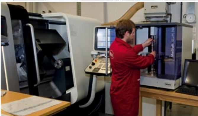
Messung einer Welle für den Elektromotor am Messplatz MarScope direkt in der Produktion
