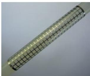
Mit dem Raster-Scanning ROT OnTheFly bietet Werth Messtechnik nun ein extrem schnelles Messverfahren für das Messen komplexer Strukturen auf rotationssymmetrischen Bauteilen an. Ermöglicht wird dieses durch die kontinuierliche Bildaufnahme während der Drehung des Messobjektes durch eine Drehachse. Sonst übliche Start-Stopp-Zyklen des Messgerätes entfallen, da
