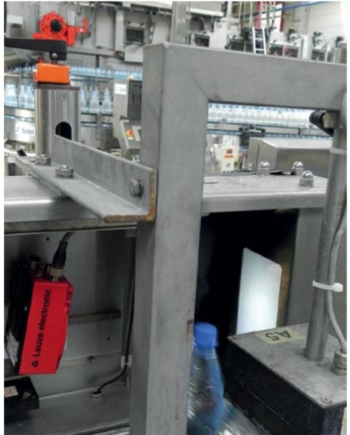
Mit gegenüber liegender Durchlichtquelle schafft die Smart Kamera LSIS 412i bei Aqua Römer eine Erkennungsleistung von 99,8 %.
