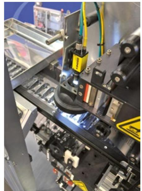
Für 100 % geprüfte Qualität sorgt das intelligente, äußerst kompakte Vision-System In-Sight Micro von Cognex.
