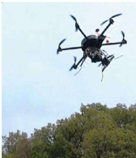
Abb. 1: R4 Robotics: Inspektionsdrohne, ausgerüstet mit mehreren optischen Inspektionstechnologien.
