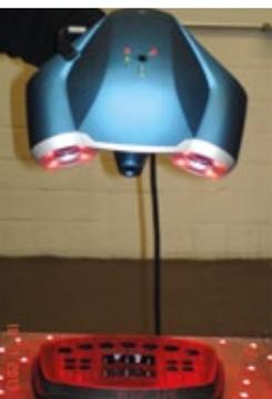
In 2011 setzte der Radladerhersteller Atlas Weyhausen erstmals den 3D Scanner REVscan von Creaform in der Qualitätssicherung ein. Das Gerät erzeugt exakte und reproduzierbare, hochauflösende 3D-Daten und spart gegenüber der herkömmlichen Messmethode Zeit und Kosten.
