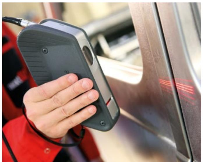
Messsystem erlaubt Messungen mit sehr hoher Genauigkeit genauso wie den durchgängigen Einsatz ein und desselben Messmittels bei allen Karosserieproduktionsschritten. Mit dem System können – wie mit Passstiften
