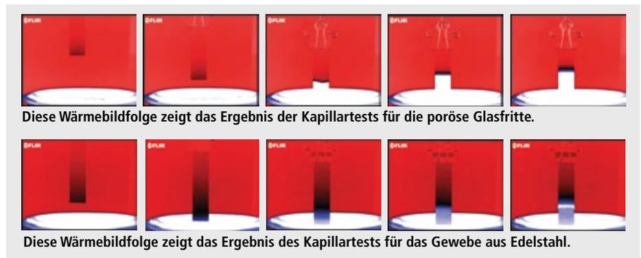
Diese Wärmebildfolge zeigt das Ergebnis der Kapillartests für die poröse Glasfritte.
