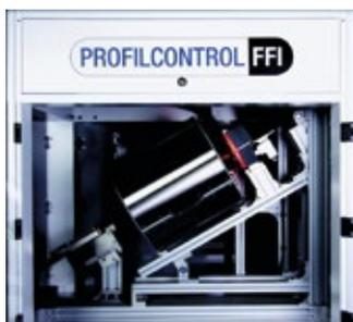
ob die Schnittkanten sauber gearbeitet sind und/oder Grate aufweisen. Auf diese Weise gewährleistet es, dass nur zu 100% geprüfte, fehlerfreie Produkte das Werk des Anwenders verlassen. [www.pixargus.de](http://www.pixargus.de)
