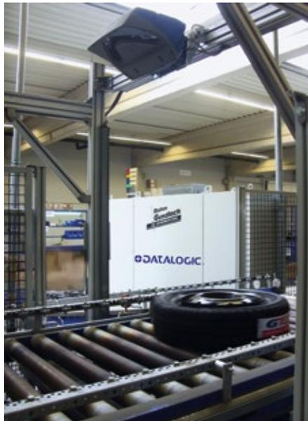
In der modernen Reifenmontagestraße sorgen mehrere Barcode-Scanner der Marke Accu-Sort, die 2012 von der Datalogic-Gruppe übernommen wurde, dafür, dass Felgen und Reifen über ein Fließbandsystem an die richtige Stelle transportiert werden. Dazu lesen die Scanner Axiom-X-SDC12904 die Barcodes omnidirektional aus.
