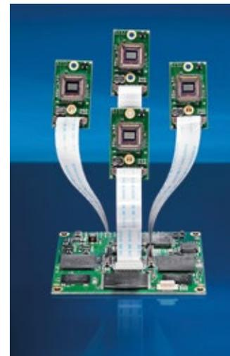
für den Einsatz als Low-Cost-Stereokamera. Sie verfügt über 32 MB Flash und 128 MB DDRAM zur Programm- und Bildspeicherung. Ihr integrierter Prozessor erreicht eine Rechenleistung von 5.600 MIPS. Zur Einbindung in Automatisierungsumgebungen dienen eine Ethernet-Schnittstelle sowie eine optionale RS232-Schnittstelle.
