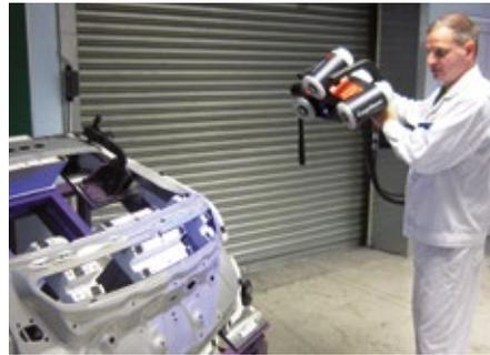
Durch den Einsatz des Weißlicht-Scannersystems Cognitens WLS400M von Hexagon Metrology konnten beim Honda Civic Ursachenanalysen beschleunigt und Prozesse verfeinert werden. Hier Messungen im Bereich der Heckklappe.
