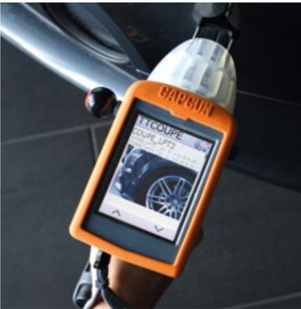
Für jedes Modell des optischen Lasermessgeräts GapGun von Third Dimension stehen unterschiedliche Messköpfe zur Verfügung, die verschiedene Anwendungsbereiche abdecken: von der Überprüfung kleiner Spaltmaße im Innenraum des Fahrzeugs bis hin zu komplexen Profilmessungen wie Spaltmaß und Versatz zwischen Tür und Karosserie.
