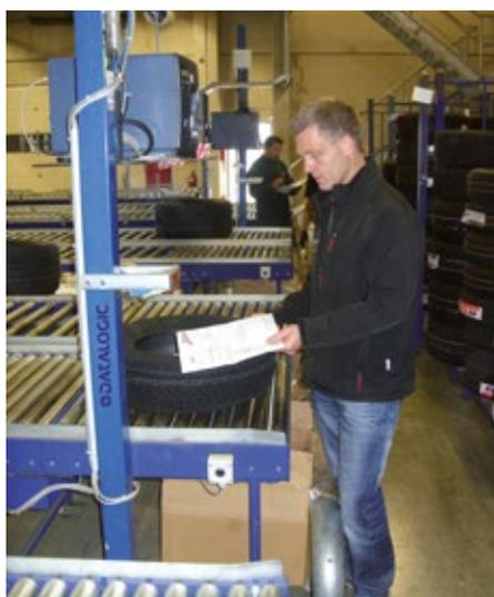
Seit Reifen Gundlach die Barcode-Scanner im Einsatz hat, erhöhte sich die Durchlaufgeschwindigkeit der Reifen von der Komplettmontage bis zum Versand bei gesunkenen Endkosten. Bis zu 4.000 Reifen durchlaufen täglich in der Hochsaison den Montage-, Verpackungs- und Versandprozess. Hier die Lesestation AL 5010 von Datalogic und Zuordnung der Reifen am Warenausgang.
