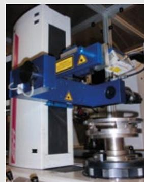
Die Präzisionsmechanik aus dem Hause Kelch ist in diesem Beispiel mit je einem 2D-Sensor (telezentrischer Aufbau) und einem 3D-Triangulationssensor ausgestattet. Für das Spannen eines Synchronrings wurde eine der Aufnahme zur Bearbeitung entsprechende Spannvorrichtung entwickelt.
