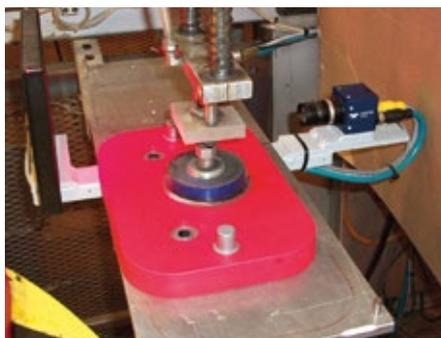
Eine Batterieabdeckung rotiert vor einem Boa Vision-Sensor, der erkennt, ob die Pole auf der Abdeckung richtig positioniert sind.
