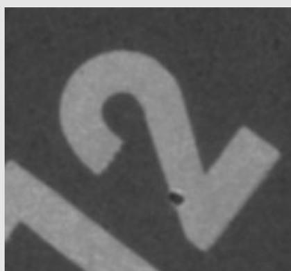
Hier hat sich ein Staubkorn in den Druck eingepägt, das in der Vergrößerung der Ziffer 2 besser zu sehen ist. Diese kleinen Fehler fallen dem menschlichen Prüfer nach einer Inspektionszeit von weniger als 15 Minuten nicht mehr auf, da das Auge schnell ermüdet. EyeCheck prüft jedoch mit zuverlässiger Qualität.
