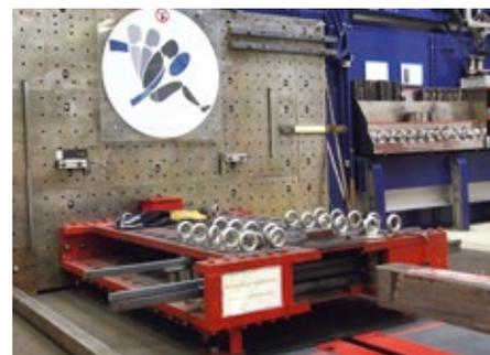
**Sie simuliert das Crashverhalten des Fahrzeugs – die Biegeblechbremse, gegen die der Schlitten im Crash prallt.**
