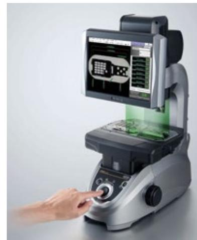
Mit der dritten Generation digitaler Messprojektoren IM zeigt Keyence auf der Control 2013 eine Version mit doppeltem Messfeld von bis zu 200 mm.
