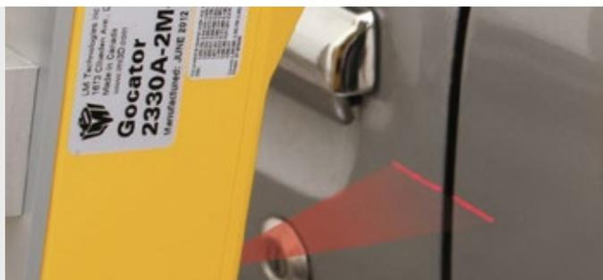
Um den hohen Anforderungen der Spalt- und Versatzmessung mit Toleranzen im Mikrometerbereich gerecht zu werden, verfügt der 3D-Sensor über eine Megapixel-Kamera – Spaltmessung links, Versatzmessung rechts.
