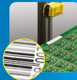
Intelligentes Codelesen mit bildbasierten Lesegeräten hat sich bei komplexen Anwendungen längst durchgesetzt. Neu ist, dass diese Technologie den Laserscanner nun auch bei einfachen 1D-Barcodes Anwendungen ablöst – und dabei Leseraten von mehr als 99% erreicht.
