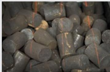
Mittels bewegter Laserlinie lassen sich die Positionen ungeordneter, zufällig verteilter Objekte in unterschiedlichen Tiefenlagen großer Behälter dreidimensional bestimmen.
