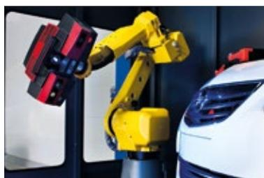
Scan 3D-Sensor, ist die ScanBox eine industrielle optische 3D-Messmaschine. Im Vergleich zu einem herkömmlichen taktilen Koordinatenmessgerät (KMG) ist die ScanBox jedoch nicht orts-
