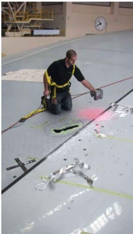
Anwendungsingenieur Sébastien Dubois scannt den beschädigten Bereich im Treibstofftank des Airbus A380.
