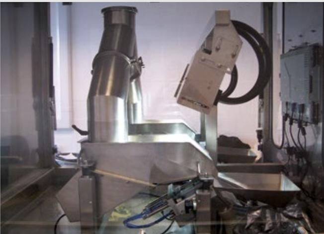
Das Inspektionssystem für Granulate verarbeitet 100 kg Material pro Stunde, mit einer Dichte ähnlich der von Streuzucker. Die Effizienz des Systems ist höher als 99%. Das System arbeitet mit dem Industriecomputer Matrox 4Sight und der Matrox Imaging Library.
