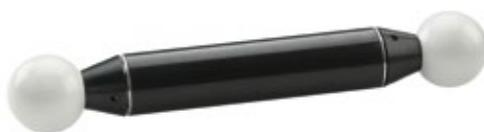
Alle Aimess Prüfkörper basieren auf ein- und derselben Komponente: dem Tetronom-Einzelstab. Dieser ist mit zwei Targetaufnahmen ausgestattet, an denen die auswechselbaren Targets (hier: Kugeln aus Spezialkeramik für optische Messsysteme) mit Magneten befestigt werden.
