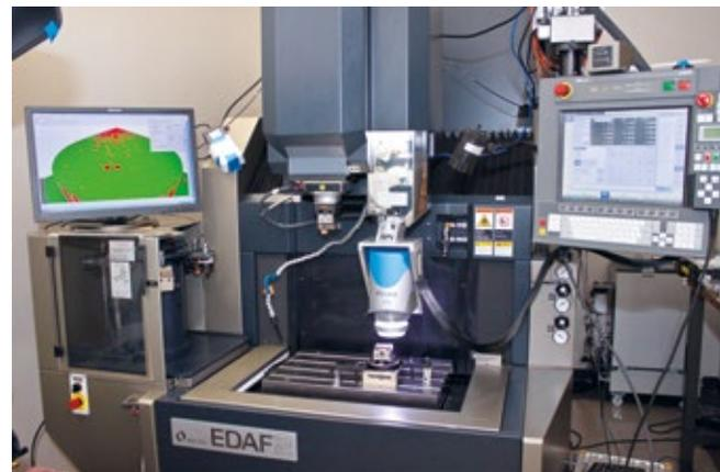
Messtechnikanbieter Alicona und Maschinenhersteller Makino stellten auf der Control erstmals eine Präzisions-Erodiermaschine auf Basis von Closed-Loop-Manufacturing vor.
