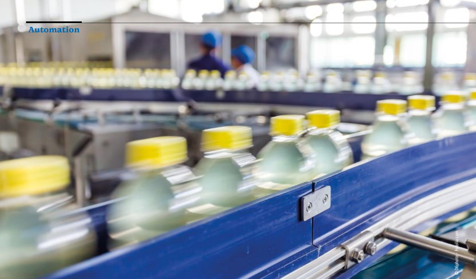
Das RPC-System von Mettler-Toledo vermisst die Flaschenhalse in der Durchlaufbewegung und erreicht Stückzahlen von bis zu 600 pro Minute.
