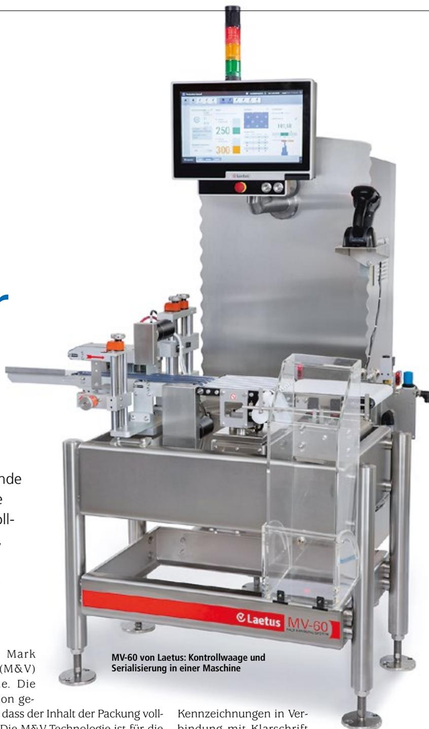
MV-60 von Laetus: Kontrollwaage und Serialisierung in einer Maschine
