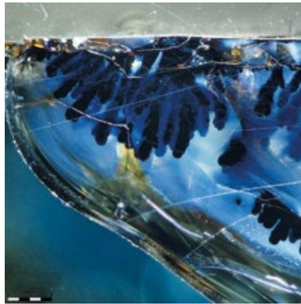
Abb. 1: Untersuchung der Entstehung von mineralischen Einschlüssen in alterndem Glas mit dem DSX500 bei Dunkelfeld-Bedingungen
