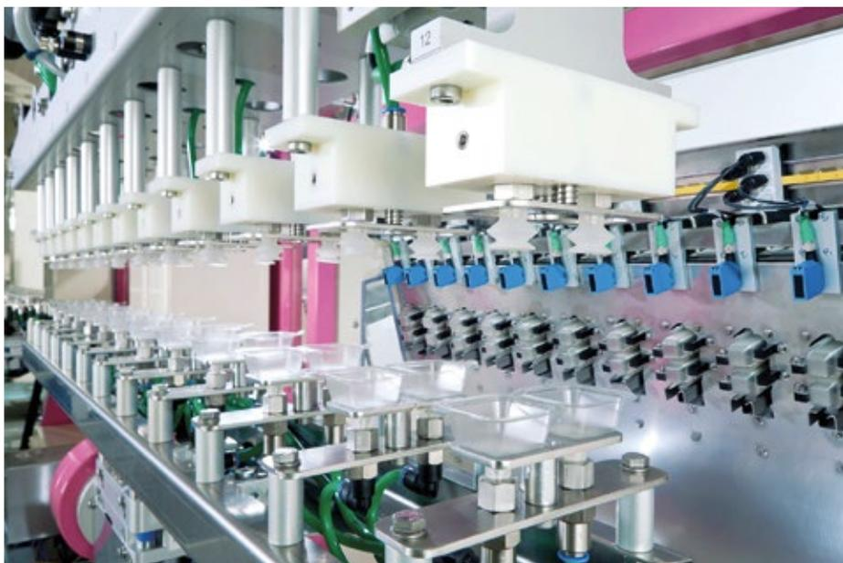
Ein TLM-F2-Roboter fügt in das Werkzeug des Transmoduls zwei Reihen Klapptrays ein.
