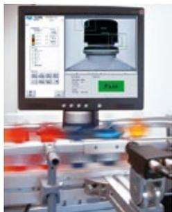
**Abb. 1: Bildverarbeitungssysteme können bei der Online-Inspektion komplexe und täglich wiederkehrende Aufgaben mit hoher Geschwindigkeit und Präzision sowie gleichbleibender Qualität ausführen.**
