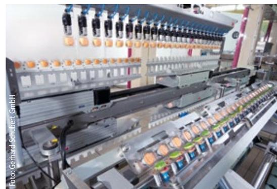
Vordergrund: Der Verschleißtisch klappt die Trays zu. Hintergrund: Die zugeklappten Trays sind seitlich stehend in eine Formatkassette eingesetzt worden. Die Formatkassette ist auf einem Transmodul installiert.
