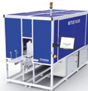
Das RPC-System erfasst Daten über die Außenabmessung, Halshöhe und Gewindebreite der noch leeren Behälter. Die Software CIVCore von Mettler-Toledo erkennt Abweichungen im 0,1-mm-Bereich.
