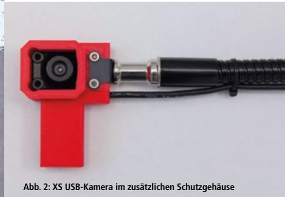
Abb. 2: XS USB-Kamera im zusätzlichen Schutzgehäuse
