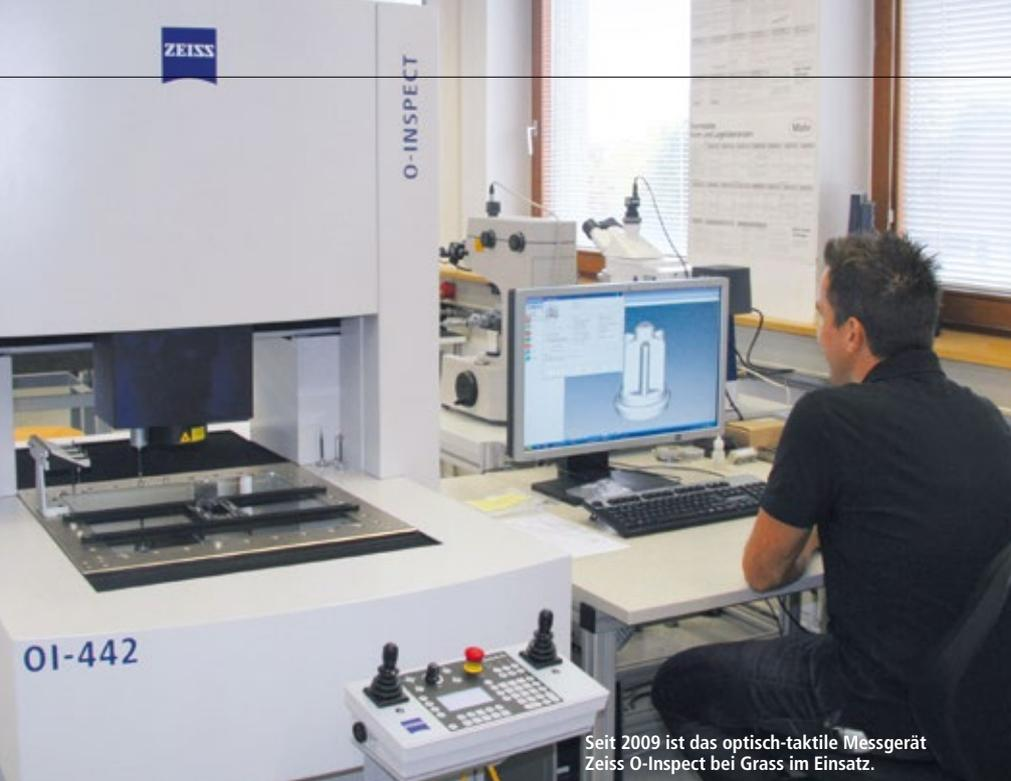
Seit 2009 ist das optisch-taktile Messgerät Zeiss O-Inspect bei Grass im Einsatz.
