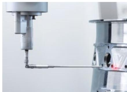
zeichnet sich aber durch eine höhere Abtastgeschwindigkeit, einen größeren Messbereich und die generellen Vorteilen einer berührungslosen Messung aus. Somit ist es eine ausgezeichnete Alternative für hochgenaue taktile Messungen, bei denen Geschwindigkeit ausschlaggebend ist, Werkstücke für taktile Messköpfe schwer erreichbar sind oder Werkstücke bei der taktilen Messung verformt oder anderweitig beschädigt werden.
