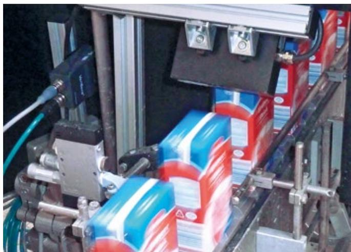
Prüfung auf Vollständigkeit einer Getränkeverpackung mit einem Verisens Vision-Sensor
