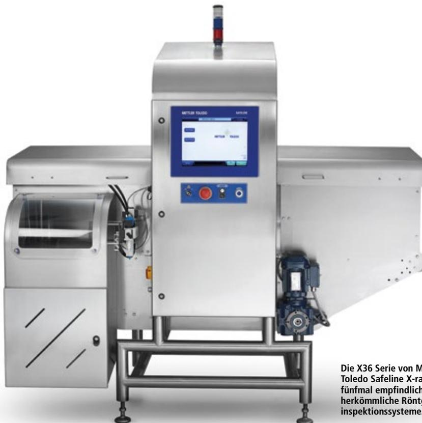
Die X36 Serie von Mettler-Toledo Safeline X-ray ist fünfmal empfindlicher als herkömmliche Röntgeninspektionssysteme.
