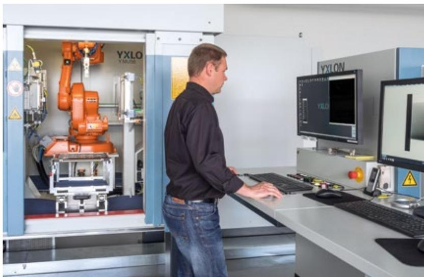
Daniel Genke, Abteilung NDT Level II und III bei AAS, bereitet sich auf die Serienprüfung der TiAl-Turbinenschaufeln mit dem vollautomatischen Röntgensystem Y.MU56 TB vor.
