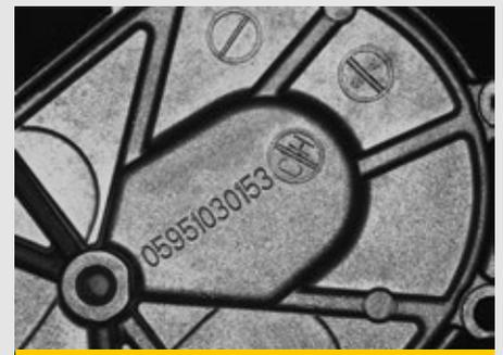
**Typerkennung einer Getriebeabdeckung – beleuchtet mit dem Luminax LED High Power Ringstrahler LR70 aus 1,5 m Entfernung**
