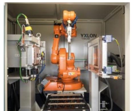
Der Roboter manipuliert die Turbinenschaufeln in die unterschiedlichen Prüfpositionen zwischen Röntgenröhre und Detektor.
