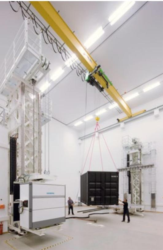
Der in rund 14 m Höhe angebrachte Deckenkran ermöglicht es, Objekte riesiger Ausmaße auf dem Drehteller in der Linac-Testhalle des Fraunhofer EZRT in Fürth zu platzieren, um diese hochauflösend zu röntgen.
