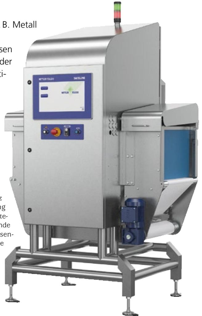
Die X36 Röntgeninspektionssystem-Serie besitzt dank ihrer verkürzten, tunnelförmigen, trennenden Schutzeinrichtungen eine reduzierte Aufstellfläche.
