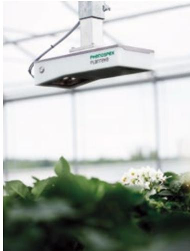
Der kompakte und robuste PlantEye 3D-Scanner wird mittels eines Transportsystems über die Beete und Pflanzen gefahren.
