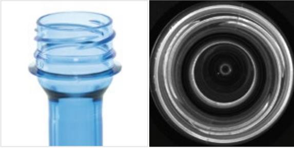
Abb. 1: Muster einer PET-Getränkeflasche und Rundumansicht des Flaschengewindes, wie es mit der Katadioptischen Linse PCCD012 aufgenommen wurde
