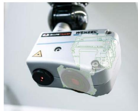
Shapetracer mit integrierter VRmD3FC-22-E von VRmagic
