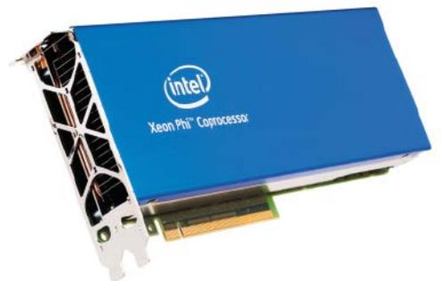
Intel Xeon Phi Coprocessor 5110P mit passiver Kühlung
