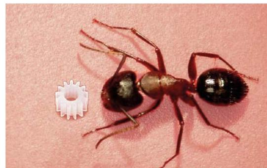
Abb. 3: Im Planetengetriebe GP6 stecken solche winzigen Planetenräder mit Modul 0,12 (Kopfkreisdurchmesser 1,908 mm, Fußkreisdurchmesser 1,347 mm, Zähnezahl 13, Material Delrin 100).
