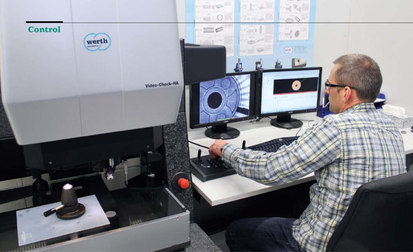
Abb. 1: Messtechniker Ralf Nutto bedient das Werth Multisensor-Koordinatenmessgerät VideoCheck HA, das mit der Software WinWerth GearMeasure ausgestattet ist.
