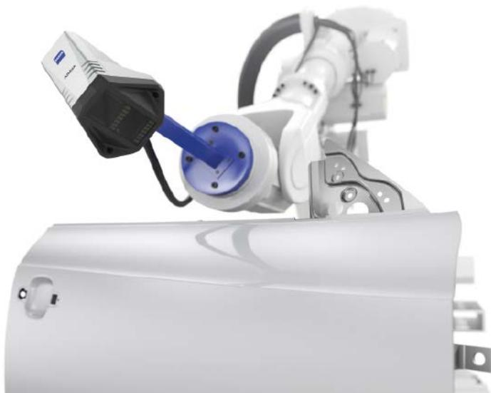
Der 3D-Messsensor Zeiss Aimax gewinnt wichtige Qualitätsdaten in der Fertigung. Er prüft z. B. nicht nur die Lage von Bolzen, Spalten und Bündigkeiten, sondern erkennt auch Typenvarianten und liest Datenmatrixcodes ein.
