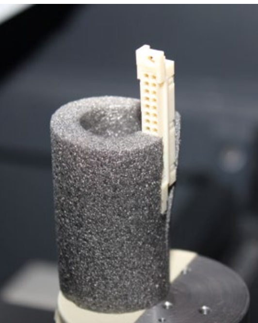
Das Koordinatenmessgerät mit Computertomographie misst unterschiedliche Bauteile ohne spezielle Vorrichtungen.
