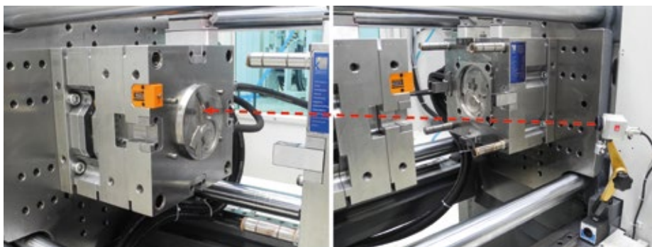
Abb. 1: Positionierung der Infrarotkamera im Werkzeug-Einbauraum
