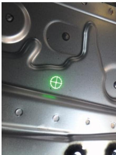
Eine Bolzenposition wird durch den Laserprojektor lasergerichtet auf das Bauteil projiziert. Sie kann somit einfach angerissen und bebolzt werden.
