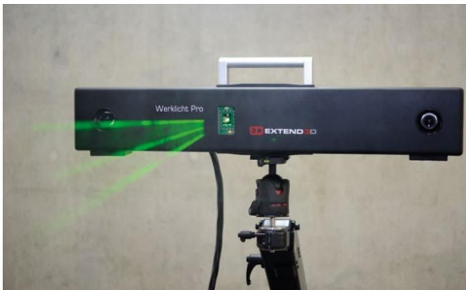
Werklicht besteht auf der Hardwareseite aus zwei Kameras sowie einem Industrielaser zur Projektion.
