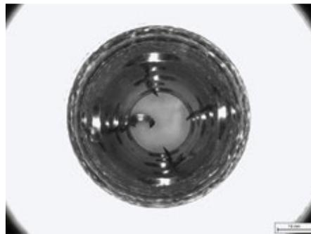
(b) Bohrlochinspektion (Durchmesser 15 mm, Tiefe 40 mm) von Querbohrungen mit fehlerhaftem Spanrückstand der Querbohrungen
