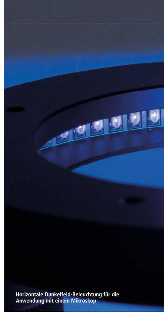
Horizontale Dunkelfeld-Beleuchtung für die Anwendung mit einem Mikroskop
