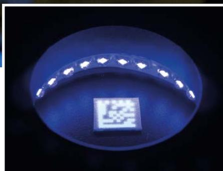
Stoffe, die unter normalem Licht nicht sichtbar sind, zum Leuchten gebracht. Paradeanwendungen hierfür sind die Untersuchung von Klebeflächen auf das Vorhandensein von Klebstoff oder das Auslesen eines, für das menschliche Auge, nicht sichtbaren Produktbarcodes (Abb. 2 und Abb. 3).
