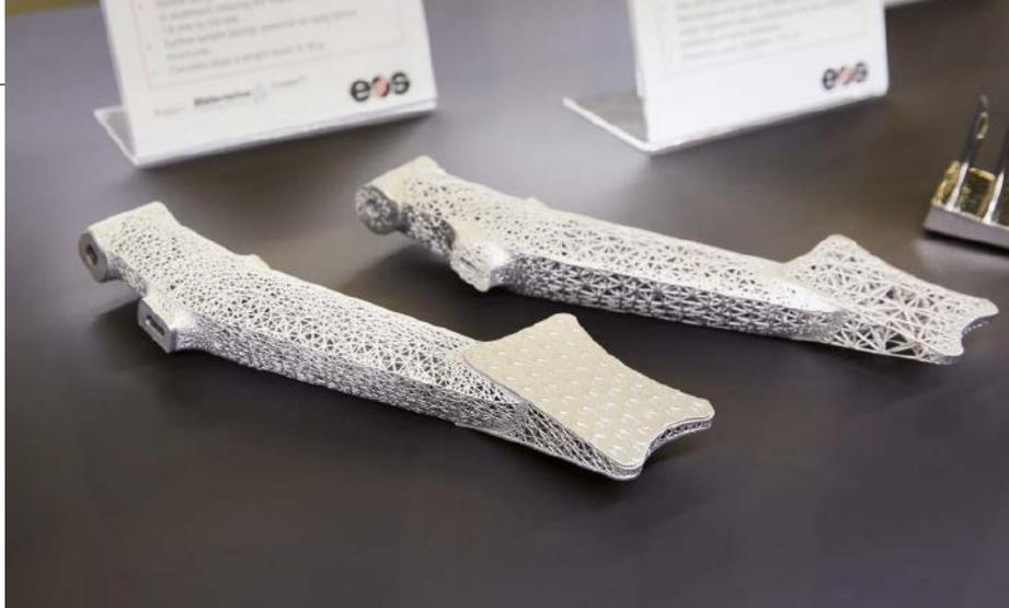
**Gewichtsreduzierung durch innovative Konstruktionsformen ist ein Hauptnutzen der additiven Fertigung mit dem Direkt-Metall-Laser-Sintern – wie hier bei einem Gaspedal aus dem Automobilrennsport.**
