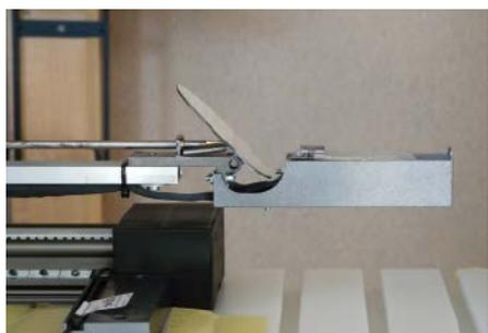
Abb. 2: Der Spiegel detektiert die Innenflächen des CFK-Rohrs, rechts daneben befindet sich die Anregungsquelle (Halogenlampe) in einer durch das Iwb additiv gefertigten, metallischen Aufnahme.
