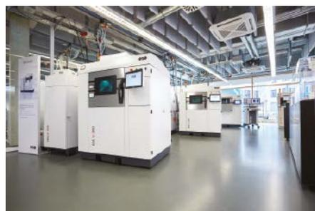
**Als erstes industrielles 3D-Druck-System für Direkt-Metall-Laser-Sintern ist die EOS M 290 serienmäßig mit dem Qualitätsüberwachungssystem Exposure OT lieferbar.**
