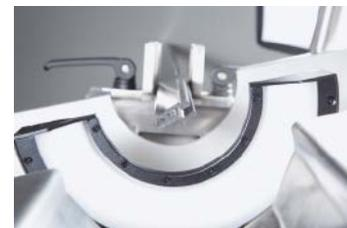
verlässig detektiert werden können. Dabei folgt das System der Produktkontur, die Inspektion erfolgt lückenlos über die gesamte Breite. So lässt sich der Sichtbereich so modulieren, dass auch gebogene Metallleisten geprüft werden können. [www.pixargus.de](http://www.pixargus.de)
