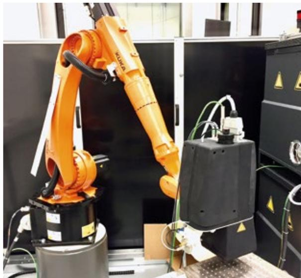
Bei Bedarf kann die erforderliche relative Bewegung zwischen Probe und bonNDTinspect auch über einen Roboter realisiert werden, der das System über das zu prüfende Bauteil führt.
