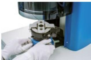
Sektorlinse) bezüglich wichtiger Parameter, wie Brechkraft, Modulationsübertragungsfunktion und MTF-Fokusscan, Orientierung und Orthogonalität der Zylinderachse torischer Linsen, Krümmungsradien und Schnittweite überprüft werden. Die Herstellungsgüte lässt sich zusätzlich visuell durch die eingebaute Kamera beurteilen. Damit die Linsen auch den praktischen Anforderungen im Auge des Patienten gerecht werden, bietet das Optispheric IOL R&D Freiräume beim Einsatz der Kornea und Filter.
