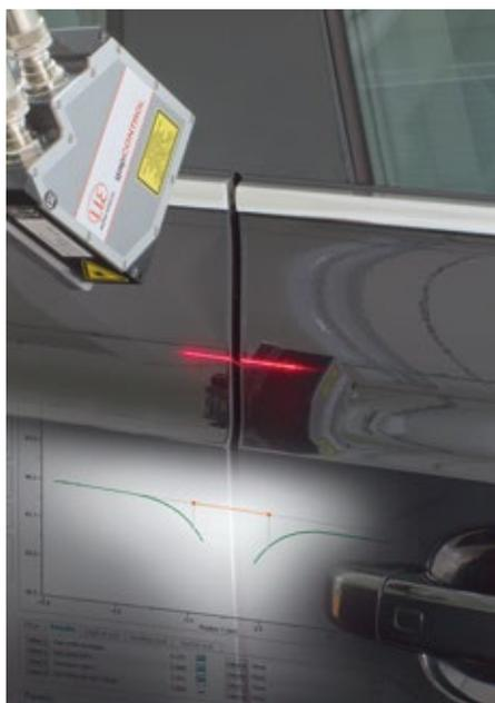
Ein wichtiges Qualitätsmerkmal von Fahrzeugen sind homogene Spaltmaße bei Cockpit-elementen oder der Mittelkonsole. Je nach Prüfsituation wird dabei ein einzelner Scanner an einem Roboterarm verwendet, der unterschiedlichste Spalte hochpräzise statisch oder auch dynamisch misst.
