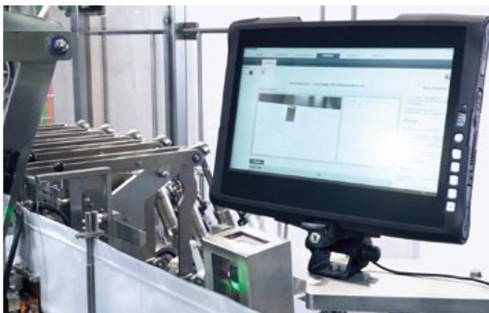
**Druckmarkenvermessung in der neuen FMH 80 – mit zusätzlichem Edelstahlgehäuse und Visualisierung auf einem Industrietablet**
