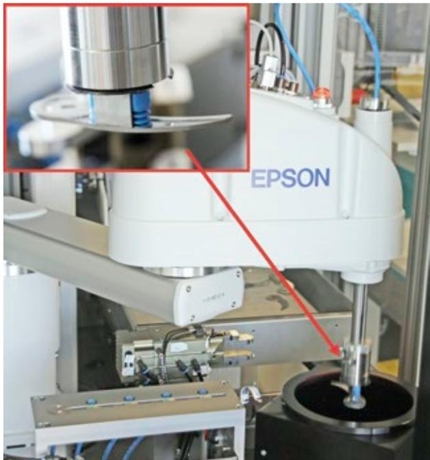
Das Handling der Teile erfolgt mit Hilfe eines Scara-Roboters, der mit einem universell einsetzbaren Sauggreifer bestückt ist. Links unterhalb des Roboters die 4fach-Pufferstation mit ihren blauen Vakuum-Anschlüssen.
