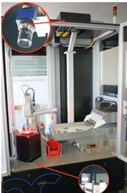
Blick in den Innenraum. Die Pfeile verdeutlichen die Position der beiden unterschiedlichen Kamerasysteme.
