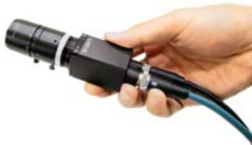
ra reicht von 0,4 MP bis 20 MP einschließlich der 5 MP Sony IMX250MZR/MYR-polarisierten 12,3 MP Sony IMX304 Global Shutter CMOS und 20 MP-Sony-IMX183-CMOS-Bildsensoren.
