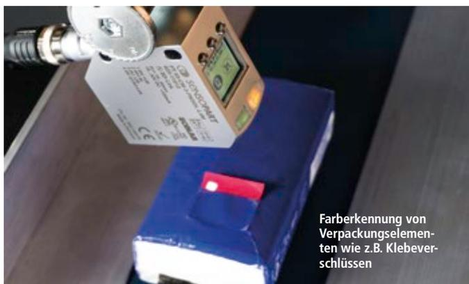
Farberkennung von Verpackungselementen wie z.B. Klebeverschlüssen
