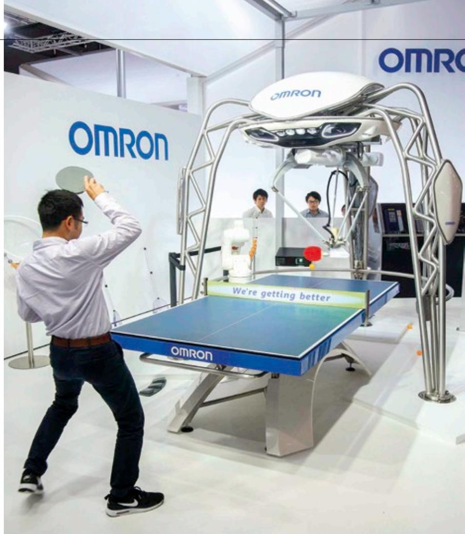
Ein Tischtennisroboter demonstriert die Zusammenarbeit zwischen Mensch und Maschine durch eine Kombination aus Bildverarbeitung, Robotik und künstlicher Intelligenz auf Maschinenebene.
