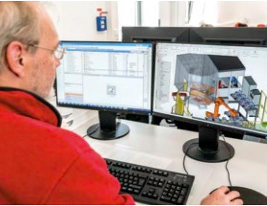
Prüfprogramme werden Offline im „Digital Twin“ simuliert und dann auf die Prüfanlage übertragen.
