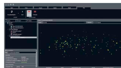
Mit der intuitiven Benutzeroberfläche Perception Studio können Anwender selbstständig Applikationen entwickeln und konfigurieren, ohne Spezialkenntnisse in Chemometrie, Spektroskopie oder hyperspektraler Datenverarbeitung haben zu müssen.
