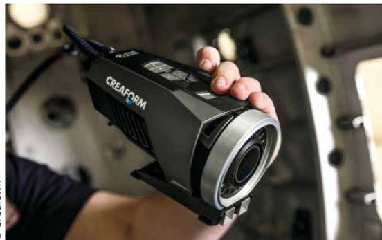
Fotogrammetriekamera MaxShot 3D zum Messen großer Objekte mit hoher Genauigkeit
