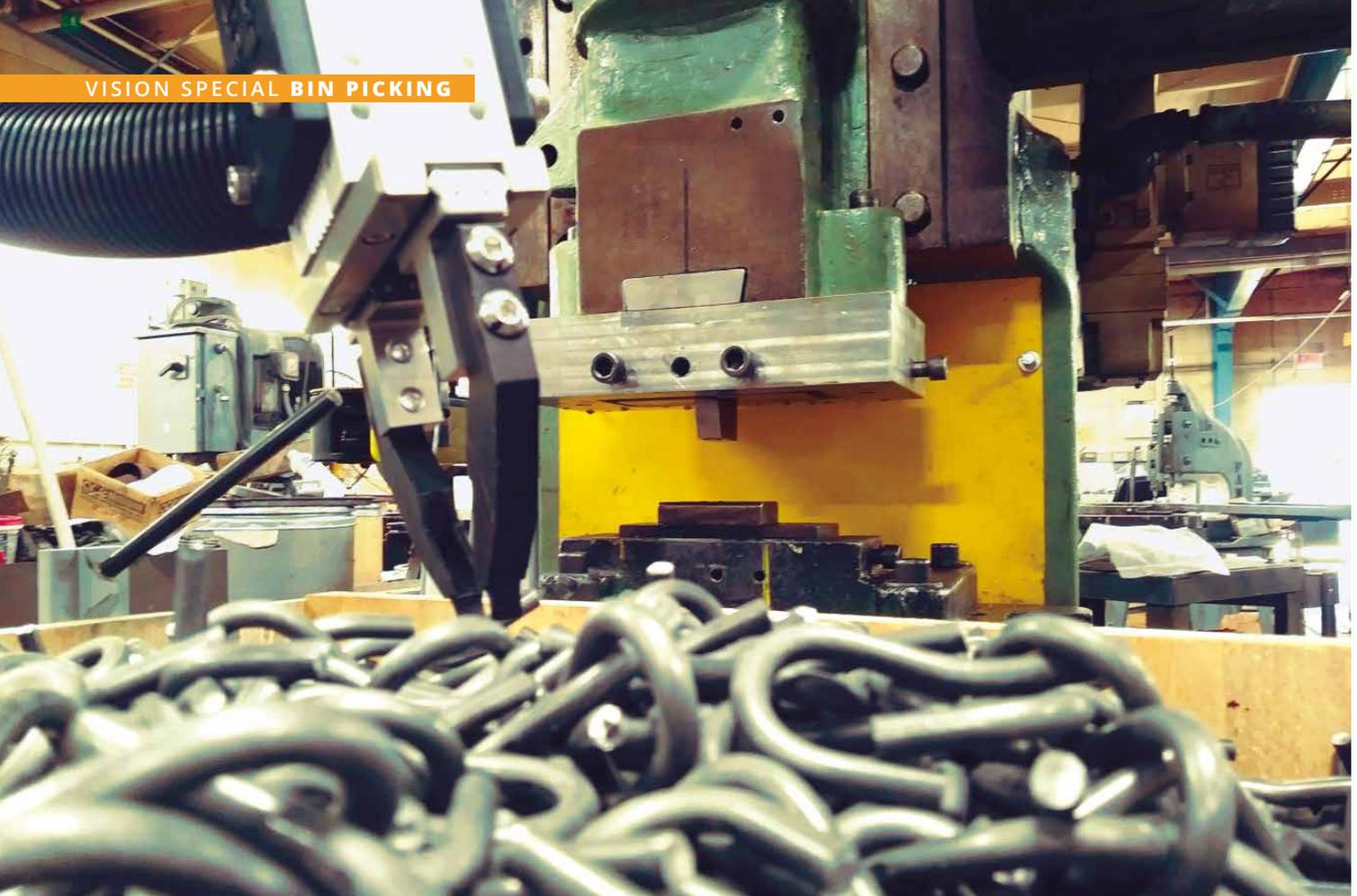
Die Software setzt auch auf Machine-Learning-Methoden, um zu entscheiden, welches Teil der Roboter als nächstes aus der Kiste entnimmt.
