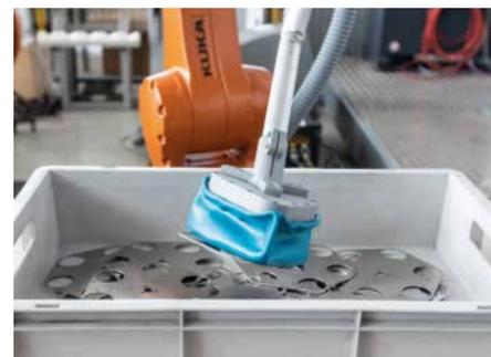
Ein mit der Firma Formhand entwickelten Greifer, der sich besonders für dünne Blechteile eignet.
