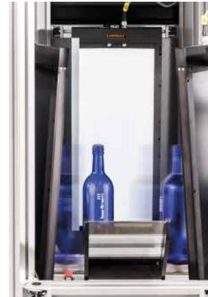
Durch die kollimierten Flächenbeleuchtungen von Lumimax zeichnen sich Kanten oder Produktionsfehler deutlich auf dem Prüfbild ab.
