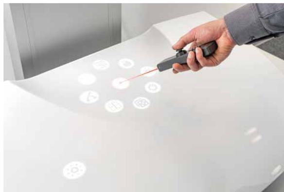
Vorteile von QSelect gegenüber der Finger-Zeigegeste: Die integrierten Tasten bieten zusätzliche Eingabemöglichkeiten. Ein Thumbstick erlaubt die Navigation durch projizierte Bedienoberflächen auf dem Bauteil.
