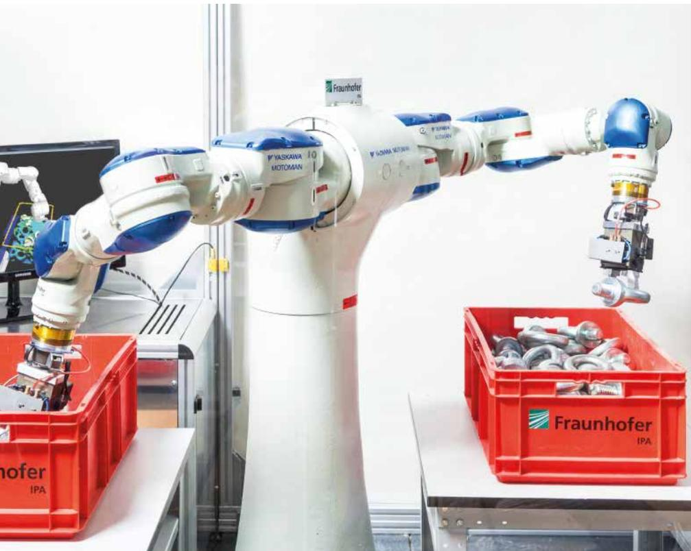
Die Software für den Griff in die Kiste ist bereits in mehreren Produktionen in Betrieb.
