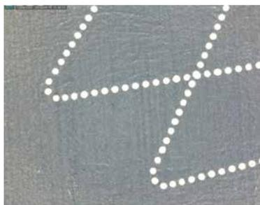
Abb. 2: Konstanter Laserpulsabstand dank SDC (Scan Distance Control) und Trajektorienplanung
