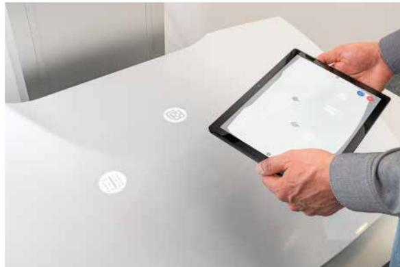
Projektion der Fehler auf dem Bauteil. Die gespeicherten Fehler können zusätzlich auf einem Tablet visualisiert werden, sodass eine Teambesprechung auch an einem anderen Ort stattfinden kann.
