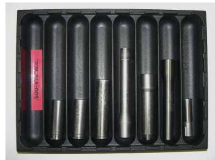
Zur Bestimmung der Maßhaltigkeit verfügt das Beschussamt Ulm über mehr als 200 Lehrensätze für unterschiedliche Kaliber.
