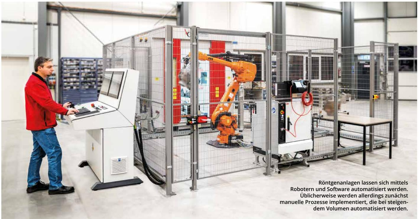
Röntgenanlagen lassen sich mittels Robotern und Software automatisiert werden. Üblicherweise werden allerdings zunächst manuelle Prozesse implementiert, die bei steigendem Volumen automatisiert werden.
