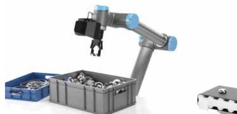
Inpicker eignet sich ideal zur Erkennung komplexer Objekte mit unregelmäßigen Formen und unterschiedlichen Strukturen. Unterschiedliche Objekte wie beispielsweise Verpackungen jeglichen Materials oder Metall- und Kunststoffteile erkennt und entnimmt das System. Die innovative Technologie ermöglicht das vollautomatische Palettieren und Depalettieren von geordneten oder zufällig platzierten Gegenständen.
