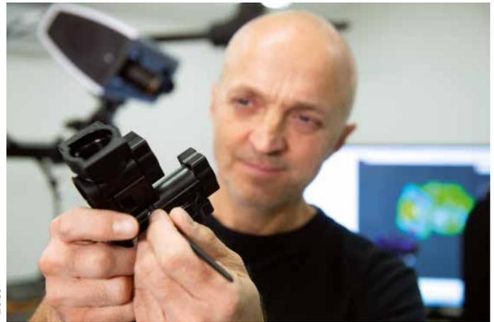
Frank Fynbo begutachtet das Gehäuse einer Wasserpumpe. Ob alle Maße stimmen, kann er aber nur nach der Prüfung mit dem 3D-Sensor entscheiden.
