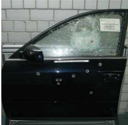
Fahrtür eines sondergeschützten Fahrzeugs, nach dem Beschuss
