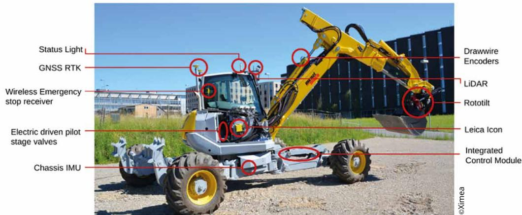
Kundenspezifischer, mit Sensoren ausgestatteter Menzi Muck M545 Roboter, genannt "Heap"
