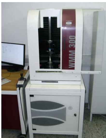
Die WMM 300 ist eine präzise Wellenmessmaschine zur schnellen Messung rotations-symmetrischer Objekte bis 300 mm Länge und maximal 80 mm im Durchmesser.
