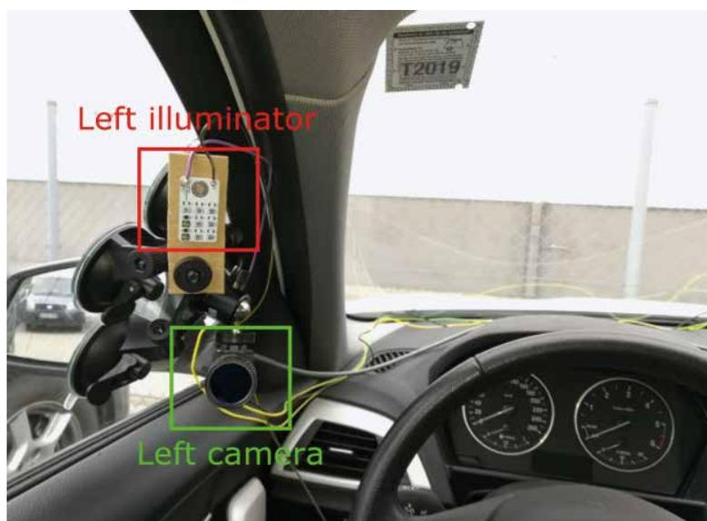
Für den Versuchsaufbau wurden in einem Testwagen zwei Kameras mit aktiver Infrarotbeleuchtung jeweils links (im Bild) und rechts des Fahrers installiert.
