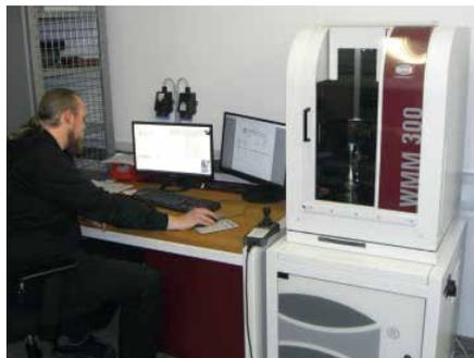
Zum Einsatz kommt die Kombination aus WMM 300 und Saphir bei der Vermessung von Lehren, die zur Waffenprüfung genutzt werden.
