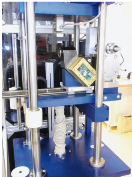
**Abb. 3: Kalibrierstation, in der die Rollierrolle gegen das Kraftmessgerät (mit Kabel) fährt.**
