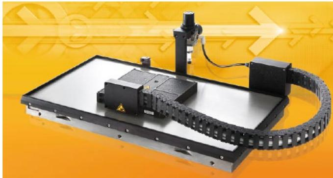
Planarantriebe positionieren schnell und mit hoher Wiederholgenauigkeit in zwei Achsen. Dazu bewegen sich auf einer Statorplatte ein oder mehrere Läufer auf einem Luftkissen.
