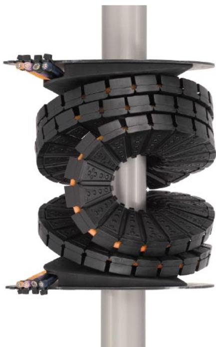
**Mit dem TwisterBand TB30 lassen sich Leitungen auf engstem Raum unterbrechungsfrei um 3.000° drehen – acht mal um die eigene Achse. Auch bei hohen Drehgeschwindigkeiten bis 720 °/s werden alle Leitungen schlank auf Achse gehalten.**
