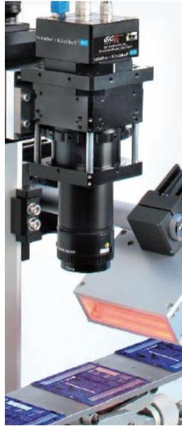
satzgebiete sind u.a. die Fluoreszenzdetektion, z.B. zur Überprüfung von Bankdokumenten und zur DNA-Analyse (Biophotonik), die Prüfung spiegelnder Oberflächen (z.B. Siliziumwafern) mit Dunkelfeldbeleuchtung und die Detektion von Mikro-Cracks bei Solarzellen (Photovoltaik).
