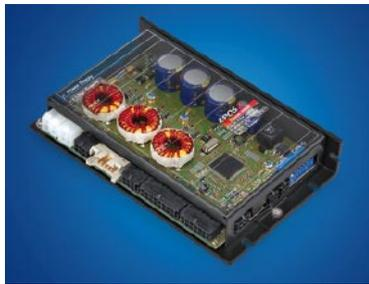
EPOS-Produkte, speziell für die Kommandierung und Steuerung im CANopen-Netzwerk entwickelt. Als weitere Kommunikationsschnittstellen stehen auch USB und RS232 zur Verfügung. Die Vielzahl von Betriebsmodi wie Position, Velocity und Current Mode ermöglichen den flexiblen Einsatz in Antriebssystemen der Automatisierungstechnik und Mechatronik. Weitere Funktionen
