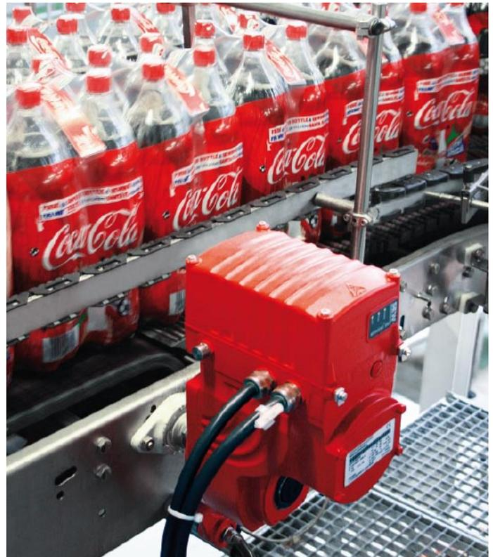
komponenten, optimierte Schnittstellen zwischen Motor und Getriebe, neue Motorenkonzepte, neue Elektronik-Bauteile und intelligente Regelverfahren erreicht, trägt jeder Teil der modernisierten Transportlinie seinen Teil zu diesem Ergebnis bei. So konnten durch den integrierten Profibus Energieersparnisse in der Pausenabschaltung erzielt und die Stillstandszeiten deutlich minimiert werden.
