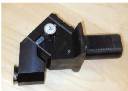
**Abb. 1: Rollierwerkzeug mit Messuhr. Setzt die Rolle auf das Werkstück auf, geben die beiden Federstähle etwas nach. Dieser Weg wurde bisher mit der Messuhr gemessen und ist ein Maß für die wirkende Rollierkraft.**
