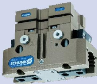
Bei der Ausgleichseinheit TCU sind die Grundplatten über Elastomer-Elemente miteinander verbunden; sie kann in X-, Y- und Z-Richtung ausgleichen, Winkelfehler korrigieren und einen Rotationsausgleich bewirken.
