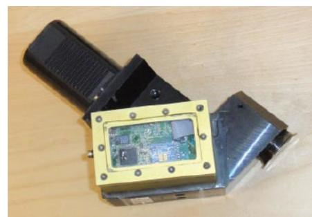
**Abb. 2: Rollierwerkzeug, bei dem die Messuhr durch einen wegabhängigen Widerstand inklusive Elektronik ersetzt wurde.**
