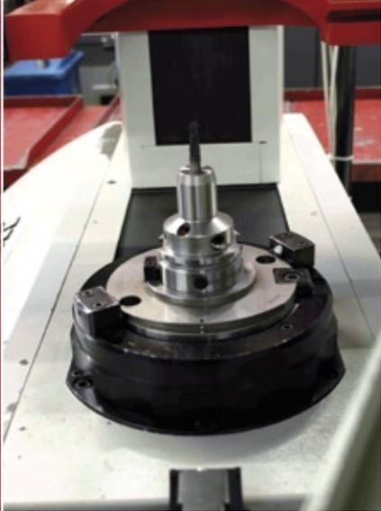
Die Kennzeichnung der Werkzeuge mittels Balluff Werkzeug-Identifikationssystem BIS-C beginnt bei Kennametal im Werk Nabburg in den Werkzeug-Voreinstellgeräten.
