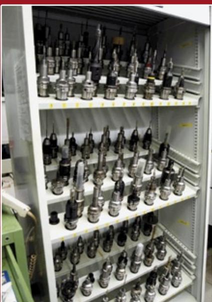
Bei über 10.000 verschiedenen Werkzeugen im ständigen Kreislauf ermöglichen die Daten auf den Chips in den Werkzeughaltern eine übersichtliche Werkzeugverwaltung.
