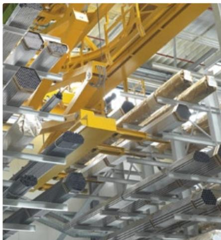
Abb. 2 und 3: Die verschiebbaren Regaleinheiten und die innovative Bauweise des Scherenhubkrans mit teleskopierbaren Gabeln und einem Drehkranz nutzen den knappen Lagerplatz bestmöglich aus.
