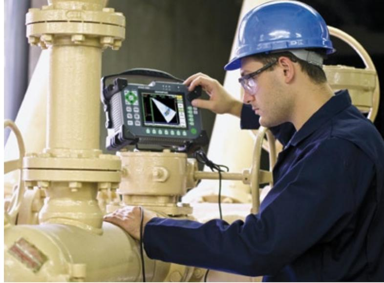
Abb. 3: Digitales Ultraschallprüfgerät Epoch 1000
