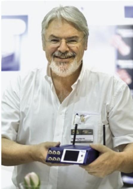
**Henning Pöschl** zeigt das neue, digitale Dx-Telemetrie-Gerät des Unternehmens **Caesar Datensysteme**. Messungen sind damit im Gegensatz zur Analogtechnik genauer und störempfindlicher. Die Funk-Telemetrie ermöglicht so Drehmoment-Messungen an Antriebswellen.
