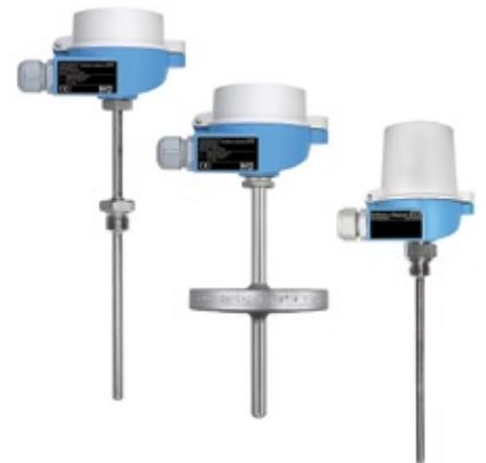
**Abb. 1: Widerstandsthermometer und Thermolemente mit Schutzrohren nach DIN43772. Der Anschlusskopf dient der Verdrahtung der Messstelle und wird zum Einbau von Meßumformern auf Einheits-signale für eine störungsunempfindliche Signalübertragung genutzt. (Quelle: Endress+Hauser Wetzler GmbH+Co. KG, Nesselwang)**
