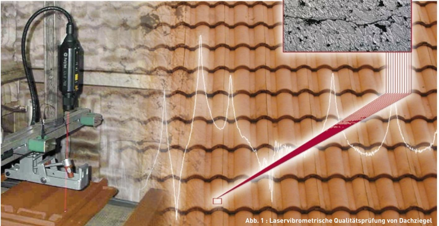
Abb. 1 : Laservibrometrische Qualitätsprüfung von Dachziegel
