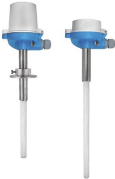
**Abb. 3: Gerade Thermoelemente mit metallischen und keramischen Schutzrohren nach DIN EN 50446 zum Einsatz bei höheren Temperaturen. (Quelle: Endress+Hauser Wetzler GmbH+Co. KG, Nesselwang)**
