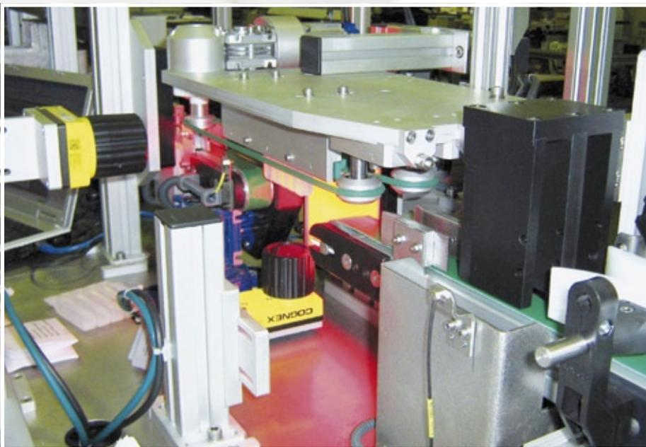
**Abb. 1:** Die penible Qualitätskontrolle der Serumfläschchen ist unabdingbar für den Produzenten. Das kompakte und autarke Vision-System In-Sight 5603 mit 2 Megapixel Auflösung garantiert für einwandfreie Ware.
