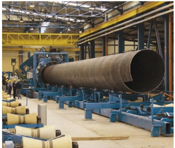
Spiralrohr mit Plasma-Schneidring
