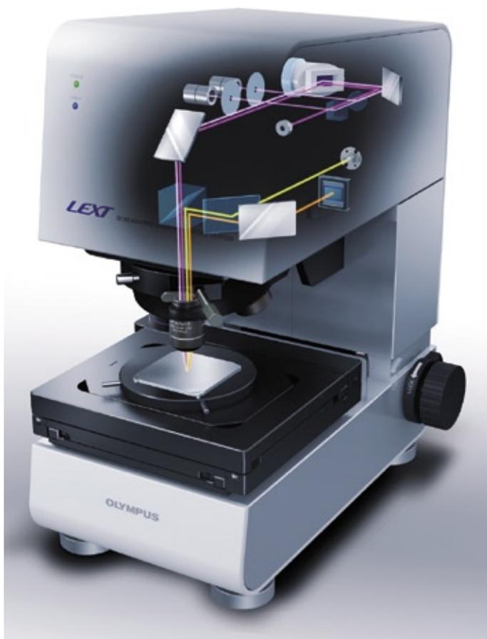
Abb. 1: Konfokales Laser-Scanning-Mikroskop Lext
