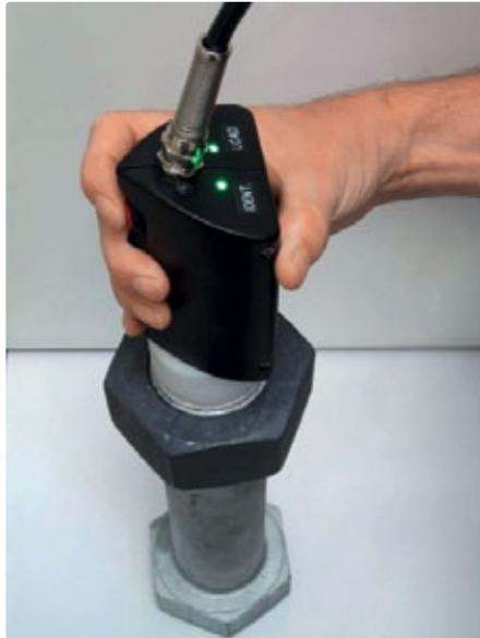
**Der Intelifast-Prüfkopf mit integriertem Barcode-Laser, Standard-Messadapter und PT100-Temperaturfühler sowie Zustandsanzeige und eine codierte Schraube mit Permanent-Sensor.**
