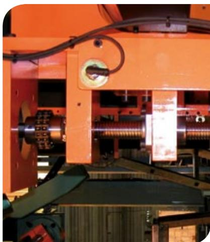
Bei der SEM-Rundschälmaschine wird der Holzblock durch Gewindespindeln auf der Schälachse eingestellt
