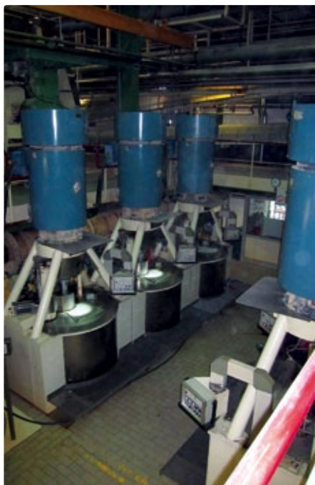
Zuckerzentrifugen in der Pfeifer & Langen-Fabrik Euskirchen befreien die Zuckerkristalle vom Sirup.
