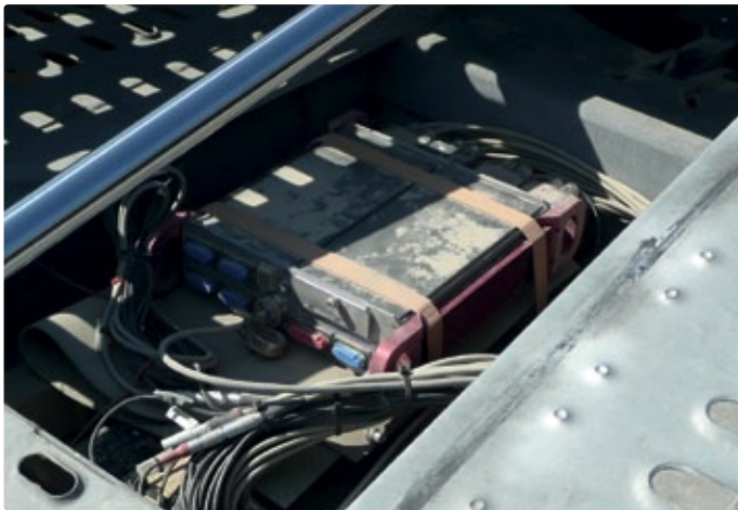
Das extra robuste Messsystem auf Basis des Imc-Cronos-PL2-Systems wurde den Anforderungen in Südafrika angepasst.
