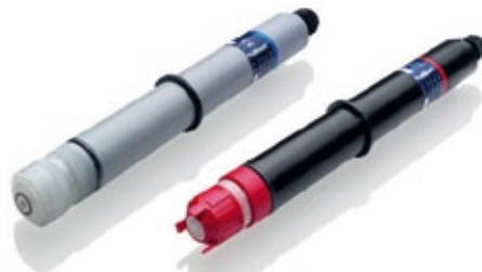
Die Dulcotest-Messzelle CDR1 CAN misst die Chlordioxid-Konzentration bei Temperaturen von 1 bis 55 °C und in einem pH-Wert-Bereich von 1,0 bis 10,0.
