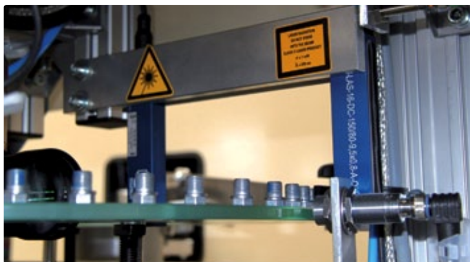
Gabelförmige Lichtschanke, die einen zeilenförmigen Laserstrahl erzeugt.
