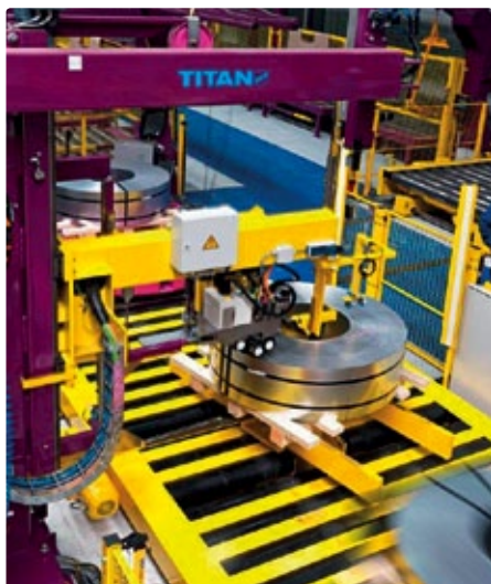
Umreifung durch das Coilage: Stahlketten von Tsubaki Kabelschlepp führen die Motorleitungen und Gasschläuche für das Umreifungsaggregat der Titan-Maschine.
