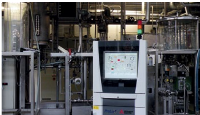
Die Prozesssteuerung des Technikumssudwerks übernimmt die Steuerung Melsec-System Q und ein Server. Beide sind im Schaltschrank (s. Abb. vorn) untergebracht.
