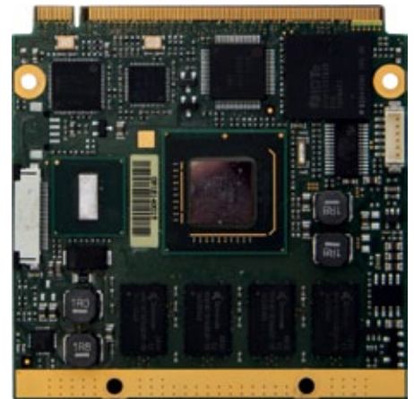
Das Qseven-Prozessormodul ist zur besseren Kühlung direkt mit dem Rechnergehäuse verbunden.
