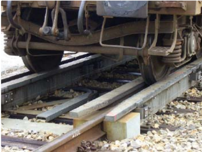
Die Gleisbremse wird über ein Magnetfeld geregelt und der Wagen beim Hindurchrollen verlangsamt.
