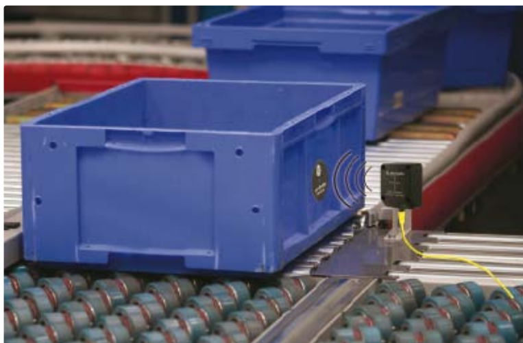
Tracken von Transportbehälter mit integrierten Datenträgern
