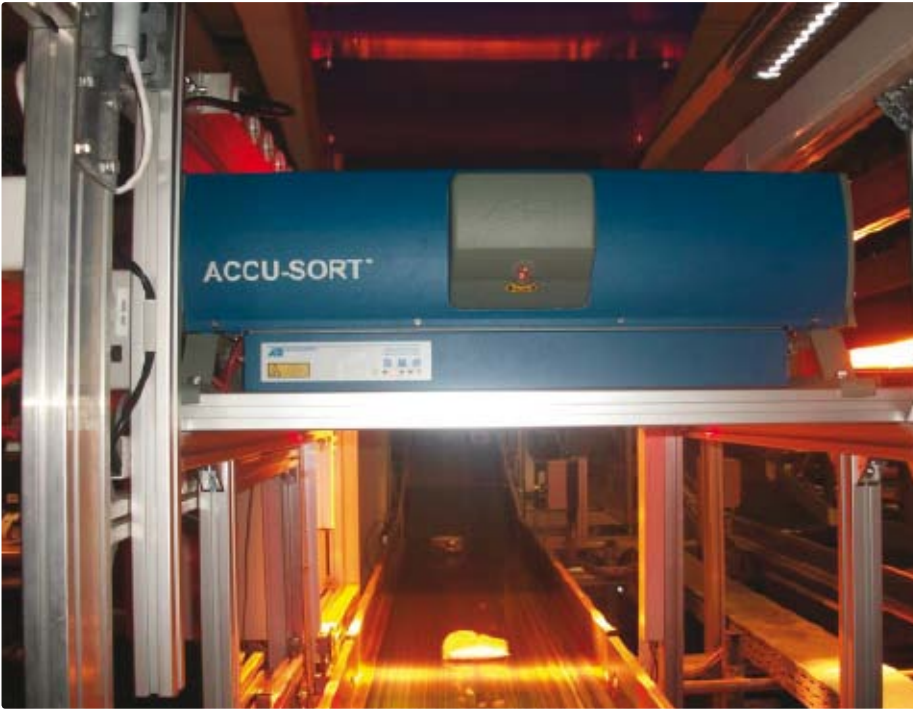
Die Hochgeschwindigkeits-Scanner lesen die Daten der Barcodes mit einer Leseratte von 99,5 Prozent auf den Verpackungen aus.
