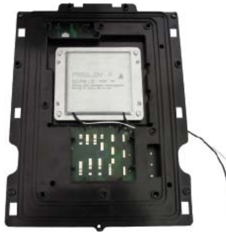
Der Bremswiderstand ist direkt ins Gehäuse integriert. Isoliermaterial trennt ihn thermisch von der Elektronik.
