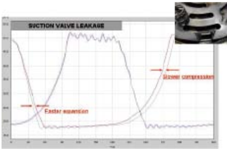
Abb. 1: Leckage am Kompressorventil – Vergleich Gut- und Fehlerzustand
