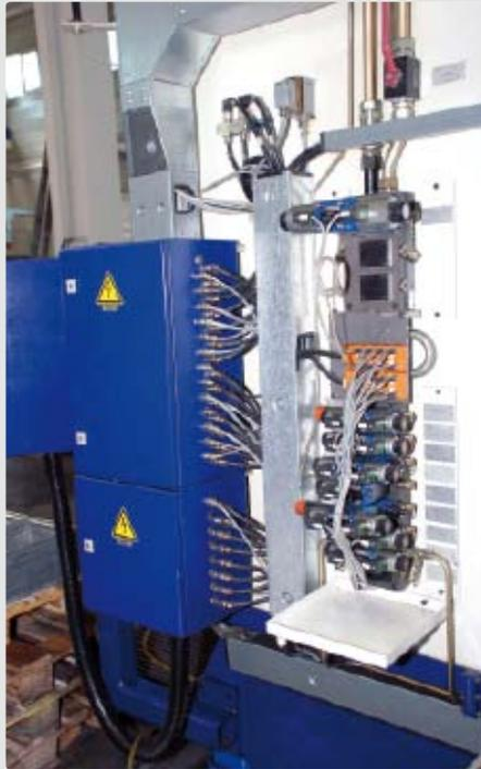
Schaltschrank einer Räummaschine ohne IO-Link mit aufwändiger Parallelverkabelung.
