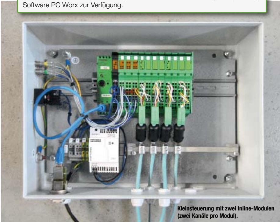
**Kleinsteuerung mit zwei Inline-Modulen (zwei Kanäle pro Modul).**
