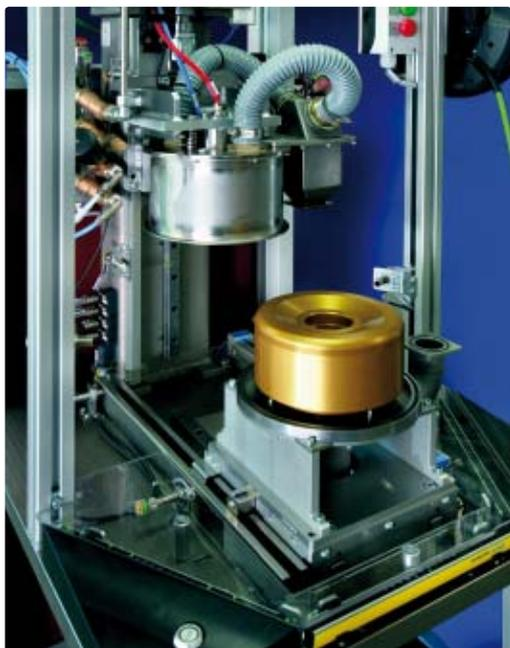
Die integrale Helium-Dichtheitsprüfung mit Akkumulationskammer wird bereits in der industriellen Serienfertigung eingesetzt – beispielsweise zur Prüfung von Drehmomentwandlern in der Automobilindustrie.
