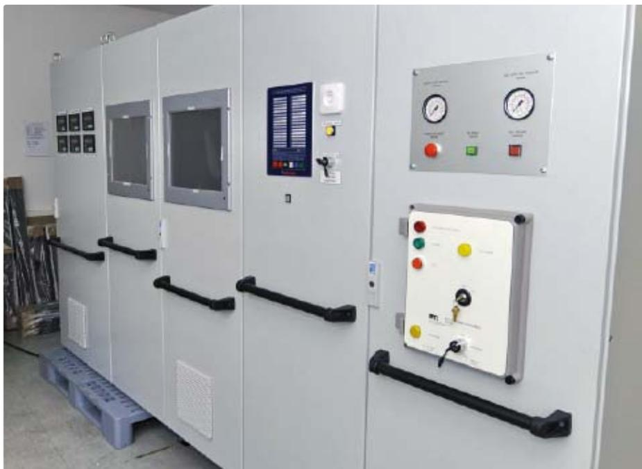
In den fünf Steuerschränken findet die Automatisierungstechnik für einen der vier neuen LPG/NH<sub>3</sub>-Tanker von Hyundai Mipo SY Platz. Realisiert wurde die Technik nach Kundenwunsch.
