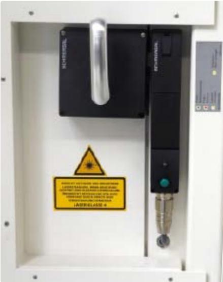
**Der AZM 200 D wurde speziell für die Laserbearbeitung entwickelt und erlaubt die Abfrage des Schutztür-Zustands „Geschlossen und nicht verriegelt“ während des Einrichtbetriebs der Maschine.**
