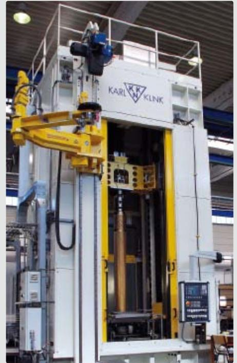
Die CNC-Drallräummaschine für Scania ist für große Räumkräfte und hohe geometrische Genauigkeit ausgelegt.
