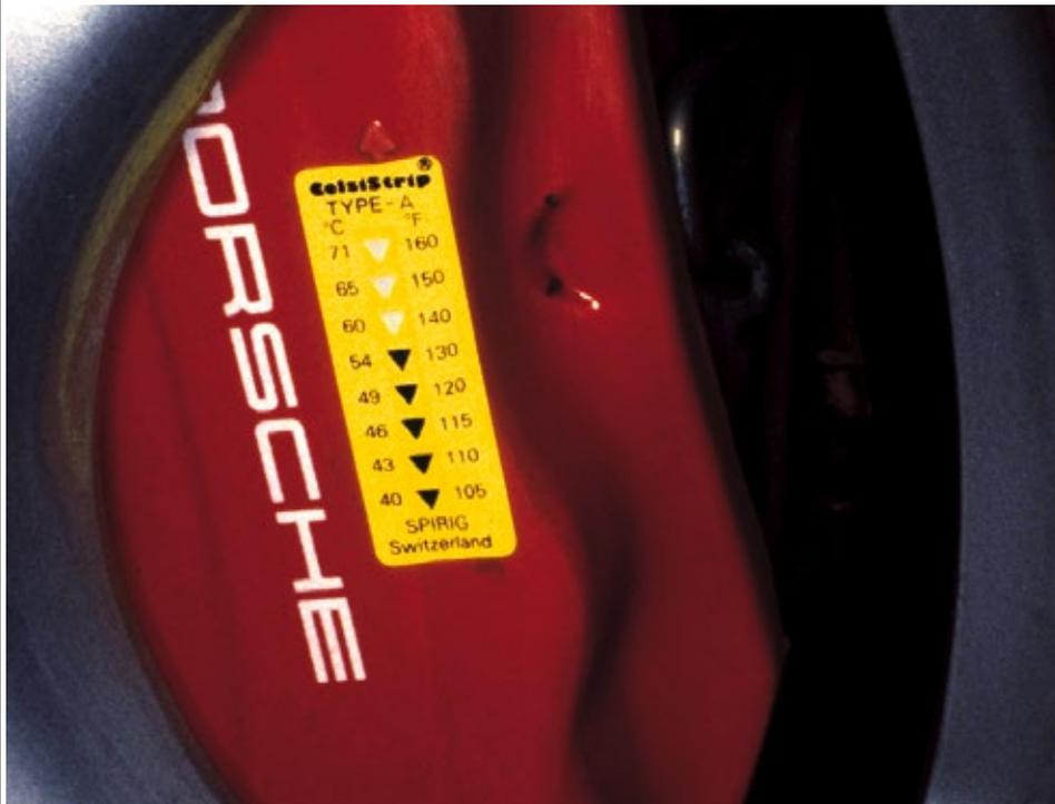
**CelsiStrip®** Die CS können zum Beispiel auf den Bremsattel eines Hochleistungsfahrzeuges aufgeklebt werden. Dieser Bremszylinder hat im Testbetrieb eine maximale Oberflächentemperatur von 54°C erreicht. Die Temperaturwerte der weiss verbliebenen Felder wurden nie erreicht.
