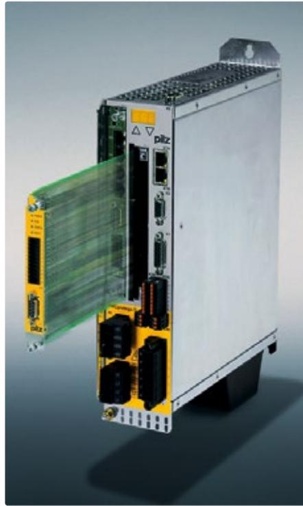
Sichere Antriebstechnik: der PMCprimo DriveP mit der Sicherheitskarte PMCprotego S.
