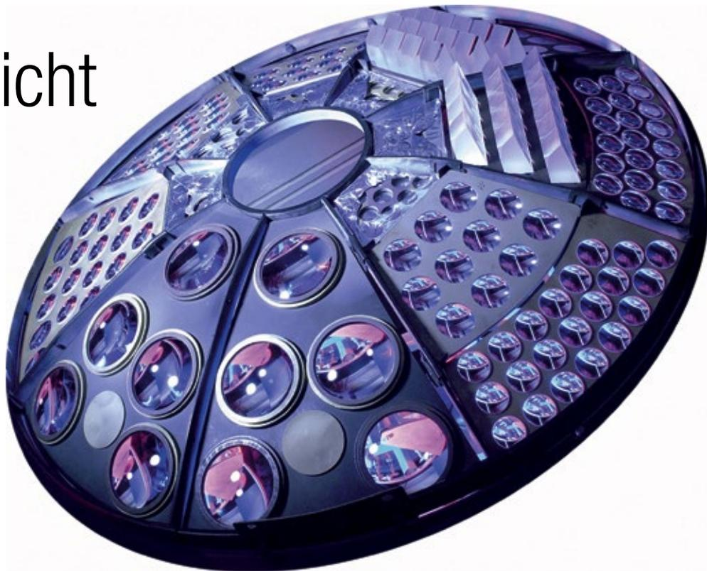
Mittels Antireflex- und dielektrischen Beschichtungen werden den Linsen je nach Anwendungsanforderung spezielle Eigenschaften, die die Transmission erhöhen, verliehen. Die mehrlagigen Schichtsysteme werden in der Qualitätssicherung genau kontrolliert.
