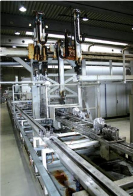
◀ Der gesamte Produktionsprozess der Achstriebgehäuse ist als Ölbearbeitung ausgelegt, sodass die Werkstücke sowie RFID-Tags und -Reader permanent mit einem Ölfilm überzogen sind. Quelle: ae group ag
