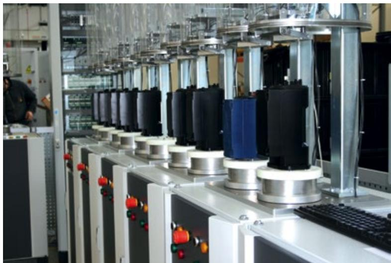
Der Integrated Servo Drive 510 muss vor der Auslieferung umfangreiche Tests überstehen.
