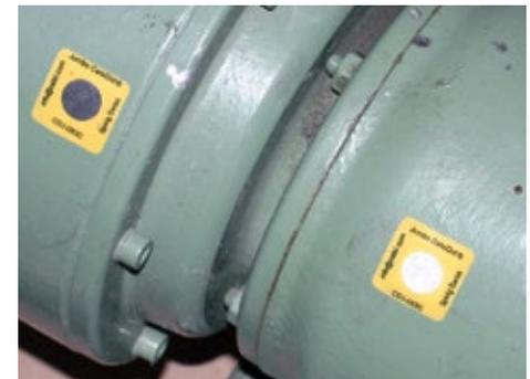
**Jumbo-CelsiDot®** mit Wert 93 °C. Der permanent schwarz verfärbte CDJ links auf dem Elektromotor hat irgendwann die 93 °C überschritten. Das angeflanschte Getriebe rechts hat diese 93 °C aber nicht erreicht. Garantiefall?
