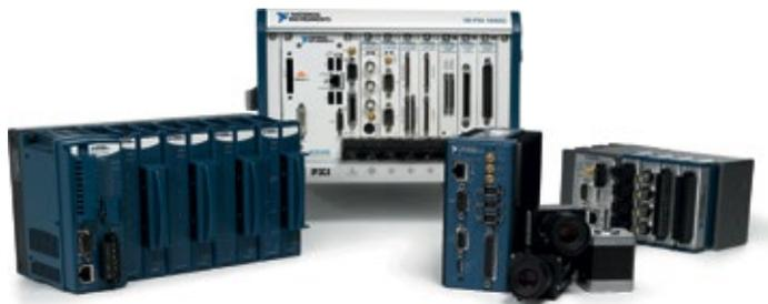
über CompactPCI/PXI bis hin zum Compact-Vision-System. So kann der Nutzer mithilfe einer kostengünstigen IEEE-1394-Kamera (FireWire) den Prototypen seiner Anwendung auf einem Labor-PC entwickeln und diese anschließend auf Produktionsebene in ein robustes Compact-Vision-System implementieren. Hierzu ist keinerlei Änderung des Datenerfassungs- beziehungsweise Bildverarbeitungs-codes erforderlich.
