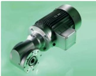
Mit dem neuen einstufigen Schneckengetriebe SN 10 BFH hat Ruhrgetriebe seine Produktpalette um eine stärkere Variante erweitert; ausgestattet als eine kompakte Flanschausführung für Hohlwellen. Dabei liegt das maximal zulässige Drehmoment zwischen 121 und 230 Nm, die Getriebedrehzahlen bewegen sich zwischen
