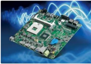
Speziell für Anwendungen im Bereich Digital Signage ist der Board-Computer AIMB-201DS im Mini-ITX-Format konzipiert. Intel-Core-Prozessoren und die ebenfalls von Intel stammende HD-Grafik mit DX-1-Unterstützung arbeiten im Herz des Rechners. Der Rechner steuert bis zu drei unabhängige HDMI-Displays an, mit dem zugehörigen Audio-Kanal. Die drei voneinander unabhängigen HDMI-Schnittstellen des AIMB-201DS unterstützen die CEC-Funktion (Consumer Electronics Control). Damit lassen sich über
