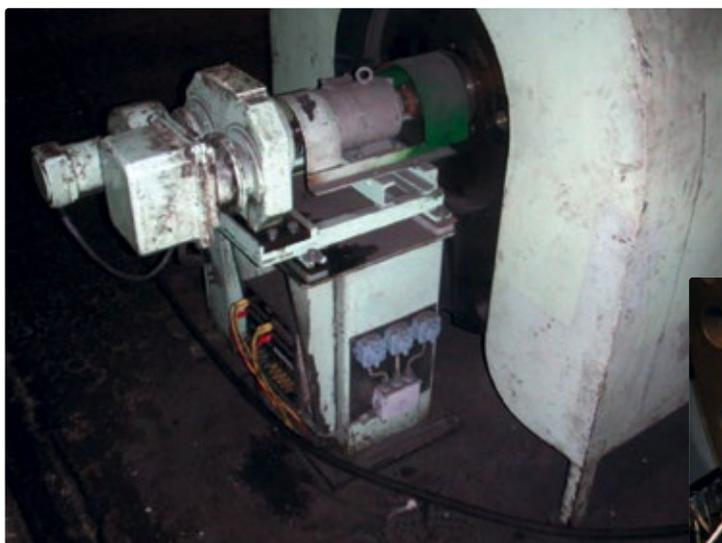
In einem Warmwalzwerk sollte die Analogtechnik mit Verteilergetriebe und Nockenschaltwerk am Hauptantrieb ausgetauscht werden (l.). Die Hübner-Lösung: Ein Hohlwellen-Drehgeber mit Austauschkopftechnik und angebaubtem Analog-Tachogenerator (r.).
