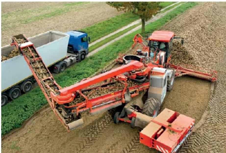
**Kollisionen vermeiden: Bis zu acht Kameraeinträge am Bedienterminal erlauben das Anschließen von Kameras und dem Fahrer eine Rundumsicht um den Vollerter.**
