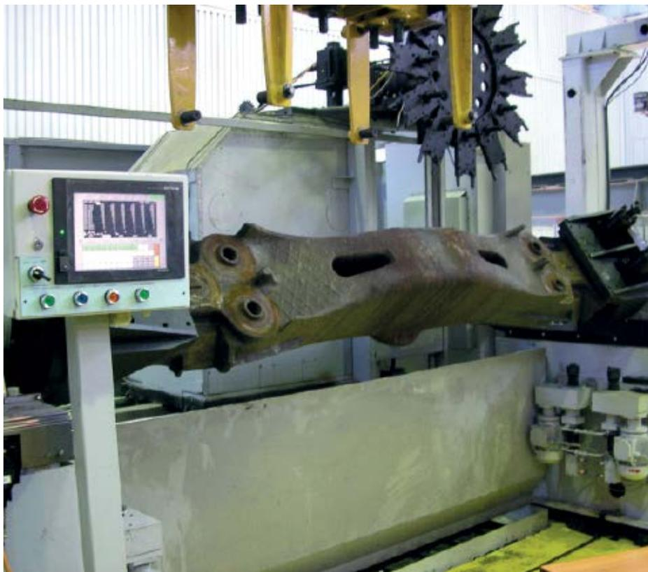
**Sichere Identifizierung: An jeder Bearbeitungsstation erfassen Lesegeräte die zur Bearbeitung erforderlichen Daten von den mitgeführten RFID-Tags.**
