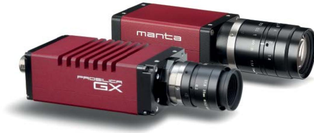
**Das Single-Gantry-System ist mit zwei Prosilica-GX1920-Digitalkameras pro Fahrspur ausgestattet, um Bilder der vorderen und hinteren Kennzeichen aufzunehmen. Zusätzlich überwachen zwei AVT-Manta-G-125B-Kameras pro Spur die Laufbahn der Fahrzeuge im Erfassungsbereich – insbesondere Spurwechsel.**
