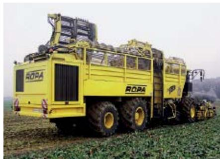
Von außen kraftvoll, von innen elektrisch: Ein Rübenvollerter (Ropa) wurde mit einem elektrischen Fahrtrieb ausgestattet, was die Geräuschentwicklung der Maschine im Feldeinsatz im Vergleich zum hydrostatischen System spürbar verringerte.
