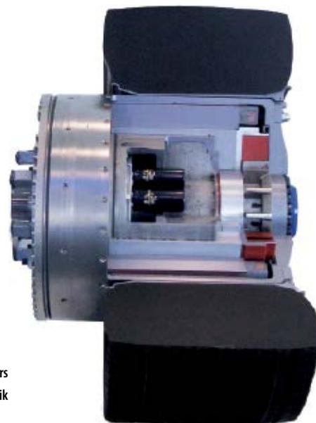
**Querschnitt des Radnabenmotors
