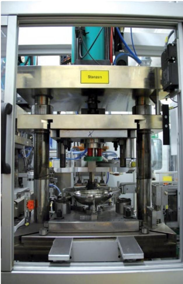
Die Tox-Press der Baureihe MBG stanzt Löcher in die Topfdeckel.
