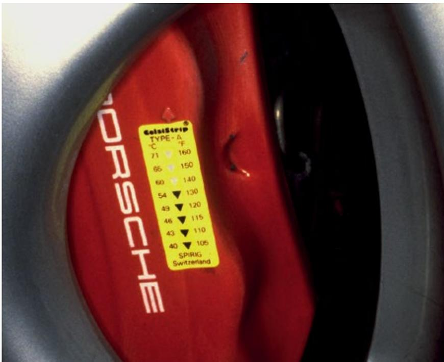
**CelsiStrip®** Die CS können zum Beispiel auf den Bremsattel eines Hochleistungsfahrzeuges aufgeklebt werden. Dieser Bremszylinder hat im Testbetrieb eine maximale Oberflächentemperatur von 54°C erreicht. Die Temperaturwerte der weiss verbliebenen Felder wurden nie erreicht.
