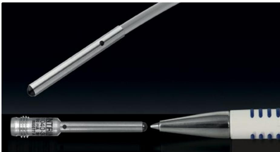
Der zylindrische Subminiatur-Lichttaster der Baureihe LTK-1040 besitzt einen Durchmesser von 4 mm und einen Schaltabstand von 20 mm.
