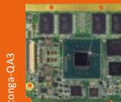
Das neue Qseven Modul conga-QA3 kann mit seiner Größe von nur 70x70mm einfach in jede Industrieanwendung integriert werden.
