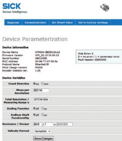
Maschinenbediener können über den Webserver aus der Ferne direkt auf den Ethernet/IP-Encoder zugreifen.
