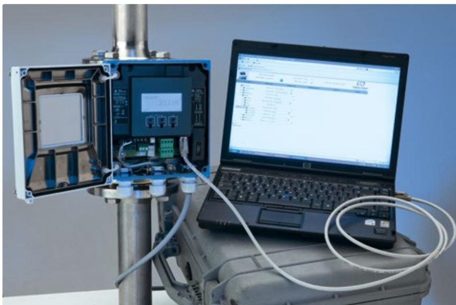
Die Webserver-Technologie ermöglicht eine zeitsparende Bedienung ohne zusätzliche Software.
