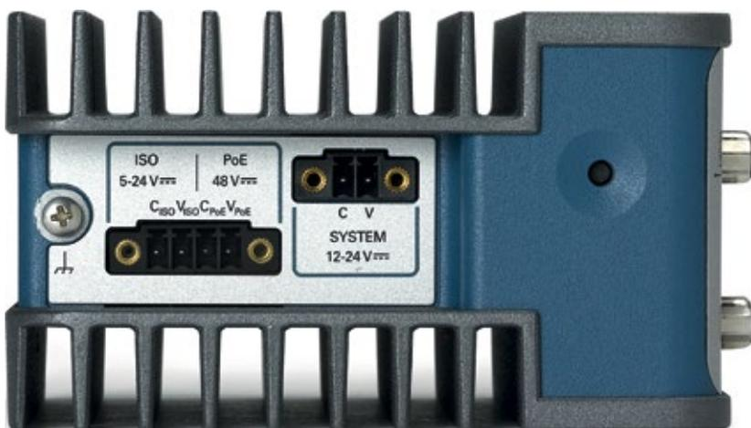
**Lüfterloses Design:** Das CVS-1457RT von NI vereint seine Funktionen in einem Formfaktor von 130 x 108 x 61 mm und spart damit in Fertigungs- und Embedded-Systemen viel Platz ein.
