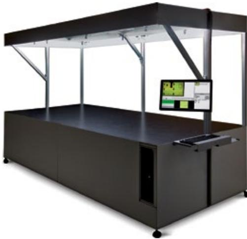
**Kameras erfassen die auf dem Prüftisch abgelegten Verkleidungsteile und vergleichen sie mit den zuvor eingelernten Prüfmustern.**
