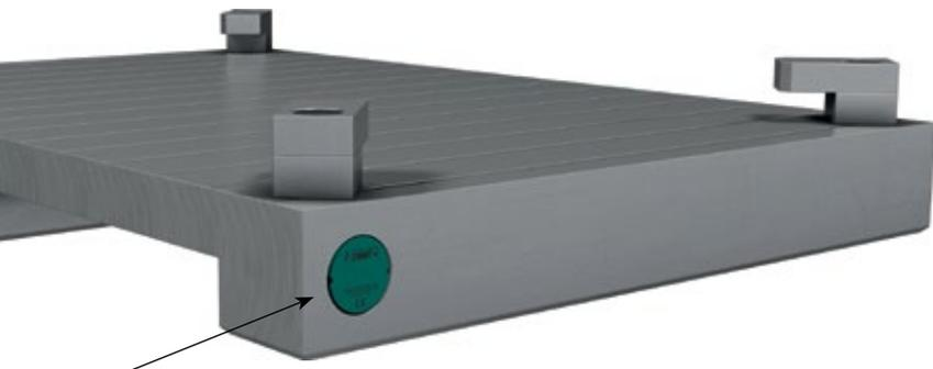
In einen Werkstückträger integrierter RFID-Datenträger
