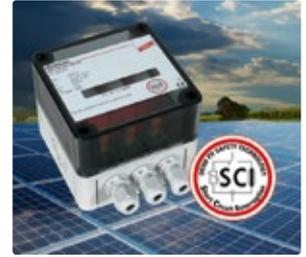
Es ist der erste Typ 2-DC-Überspannungs-Ableiter für PV-Anlagen zur Installation außerhalb von ISO-Verteilern. Bei Überlastung erfolgt eine sichere elektrische Trennung und Löschung des DC-Schaltlichtbogens durch ein Schaltungskonzept mit integrierter Sicherung im Kurzschlusspfad.
