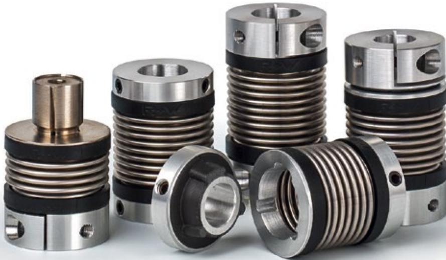
Die Miniatur-Metallbalgkupplungen der Serie MK: Charakteristisch sind hier die hohe Verdrehsteifigkeit sowie die exakte Übertragung des Winkels und des Drehmoments.
