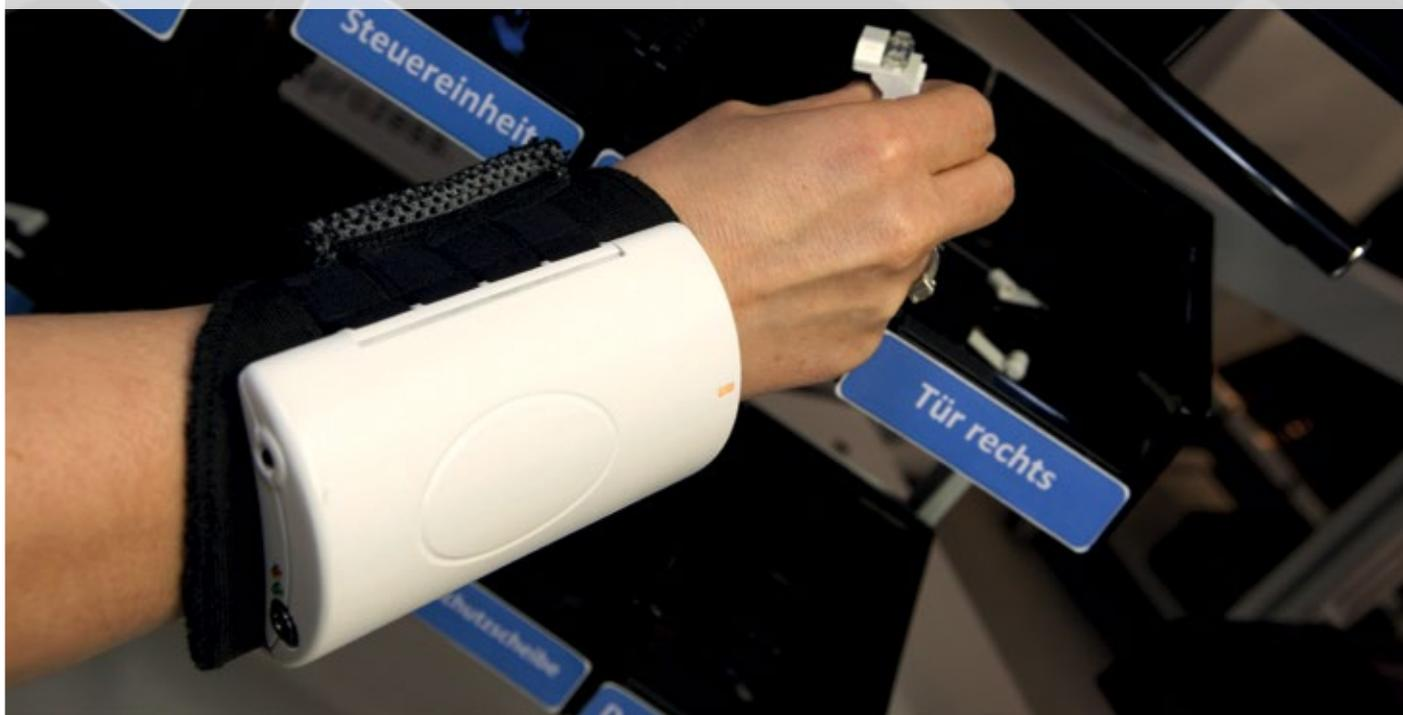
Mobile Geräte zur dezentralen Datenerfassung und -kommunikation stellen einen wesentlichen Bestandteil RFID-basierter Infrastrukturen dar. Das neu entwickelte RFID-Armband sorgt nun vor allem an manuellen Arbeitsplätzen für freie Hände, da mit jeder Handbewegung die RFID-Transponder an den Bauteilen oder Greifschalen automatisch erfasst und registriert werden und zusätzliche Arbeitsschritte wie die Objektidentifikation mit Handhelds entfallen.
