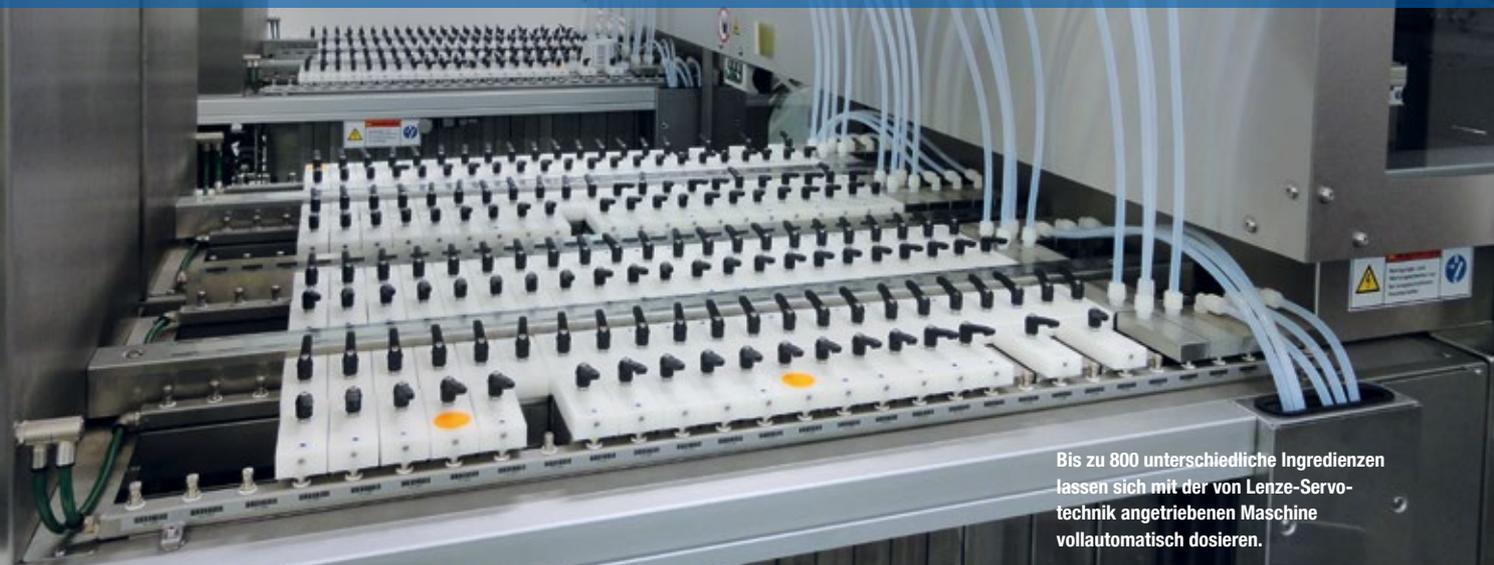
Bis zu 800 unterschiedliche Ingredienzen lassen sich mit der von Lenze-Servo-technik angetriebenen Maschine vollautomatisch dosieren.
