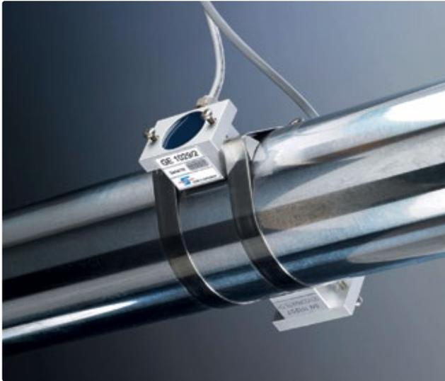
**Der Aufpresssensor GE1029 wird paarweise montiert, wobei sich beide Module zur Biege- kompensation genau gegenüber- liegen müssen.**
