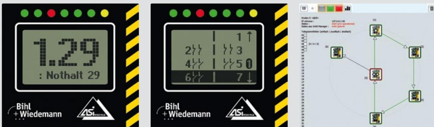
Die sichere Kleinststeuerung bietet unterschiedliche Diagnose-Möglichkeiten: Spontandiagnose, Schaltzustände, Diagnose über die sichere Querkommunikation.
