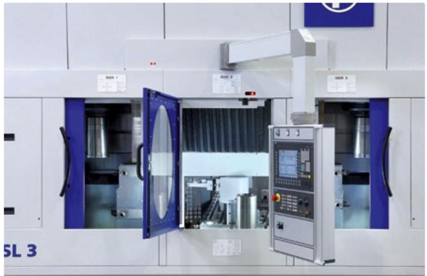
**Die spanabhebenden Verfahren, wie sie in den Bearbeitungszentren und -maschinen von Pittler zur Anwendung kommen, erfordern einen zuverlässigen Schutz der Bediener vor sich lösenden Werkstücken, abgebrochenen Werkzeugteilen, heißen Spänen sowie Ölen und Kühlmitteln.**
