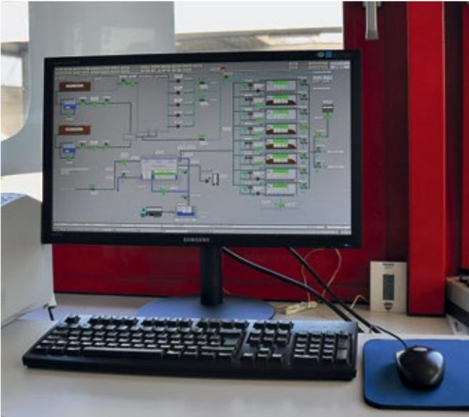
**Sämtliche Prozesse im Komppark – hier die Luftführung mit Sinamics-G120P-Umrichtern – können zentral über Simatic WinCC bedient und beobachtet werden.**
