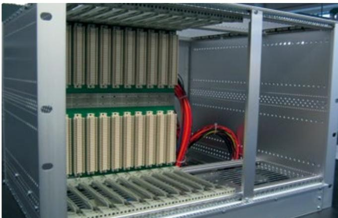
Die Systemplattform umfasst 19"-Baugruppenträger, VMEbus-Backplane, Netzteil und Lüfterzeile.
