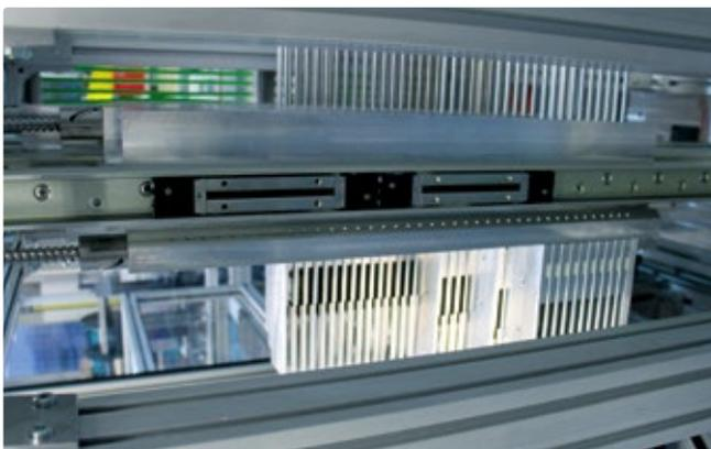
**Kennzeichenprägung für ganz Schweden: Die SNK-Führungen sorgen für schnelle und störungsfreie Bewegungsabläufe innerhalb der Prägemaschine.**
