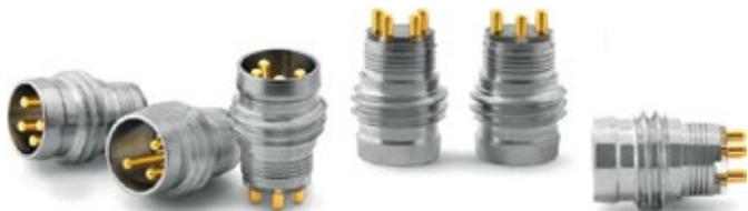
Binder erweitert sein Produktportfolio: Da vielfach nur Einbaustecker ohne LED-Bohrungen verwendet werden, hat Binder jetzt auch diese Version im Angebot. Das Metallgehäuse besitzt einen Einpressbereich mit Dichtwülsten. Als Einpressbohrung werden 5,77 mm und 0,03 mm empfohlen. Der Durchmesser kann in Abhängigkeit von verwendetem Material, Wandung und Dicke abweichend sein. Der Elektronikanschluss erfolgt über Tauchlötkontakte.
