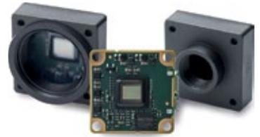
Die ersten Basler-Dart-Modelle liefern 1,2 MP bis 5 MP Auflösung und Bildraten bis zu 54 Bildern pro Sekunde. Weitere Modelle folgen im kommenden Jahr. In den Kameras kommen Aptina-CMOS-Sensoren zum Einsatz. Alle Modelle sind mit drei Mount-Varianten verfügbar, S-Mount, CS-Mount und ohne Mount (bare board). Die Bareboard-Variante misst 27 x 27 mm bei 5 g Gewicht, die beiden Mount-Versionen nur 29 x 29 mm bei rund 15 g.
