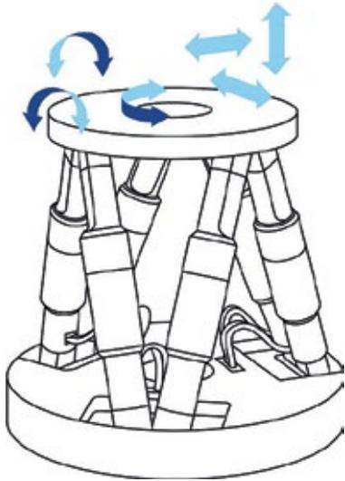
**Prinzipaufbau: Bei parallelkinematischen Systemen wirken alle Aktoren unmittelbar auf die gleiche Plattform.**
