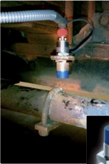
◀ Dicht an die Lenkstange montiert, überprüft ein Näherungsschalter die Mittelstellung des Lenkers bei Schienenbetrieb.
