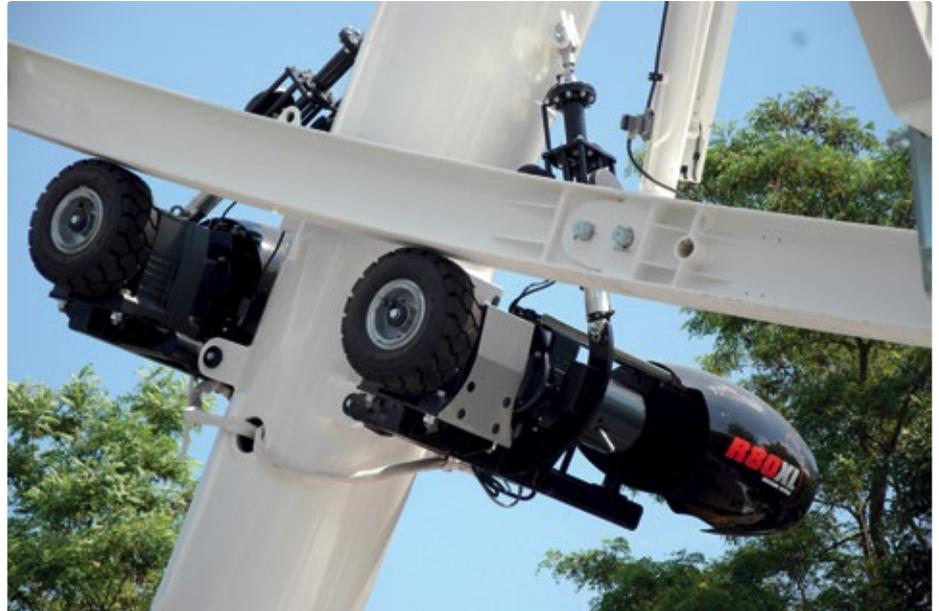
Jedes der acht Antriebsräder des R80XL ist mit einer eigenen Stelleinrichtung versehen, die den Anpressdruck optimal regelt. Integriert sind die Motoren der Reihe Simotics GP.
