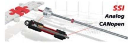
den Weg in alle Industrie-Anwendungen. Die bisher verfügbaren Schnittstellen Analog (Strom/Spannung) und CAN bedienen Anwendungen in der mobilen Hydraulik. LMR 48 sind wie alle magnetostriktiven Messsysteme von TR berührungslos und verschleißfrei. Der bewegte Teil ist ein passiver Magnet, der kein Schleppkabel benötigt. Das Hüllrohr ist druckfest und wird direkt in den Zylinder eingebaut, die standardisierte Geometrie des Messsystem-Kopfes dichtet den Zylinder ab. Durch die Bauform
