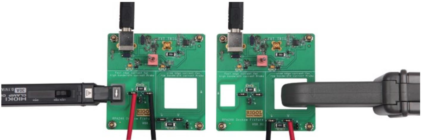
Die Spannungs-/Stromversorgung des Korrekturadapters RPA246 wird mit dem Oszilloskop oder dem PC per USB-Kabel bereitgestellt. Es gibt zwei Anschlussmöglichkeiten (eine große und eine kleine Strom-Schleife), je nachdem welche Stromzange (max. Kabeldurchmesser bzw. max. Messstrom) verwendet wird. Beide Möglichkeiten sind in der Abbildung dargestellt.
