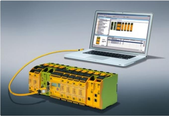
**Die Motion-Monitoring-Module des konfigurierbaren Steuerungssystems Prozmulti 2 überwachen die Antriebe im Sicherheitssystem.**
