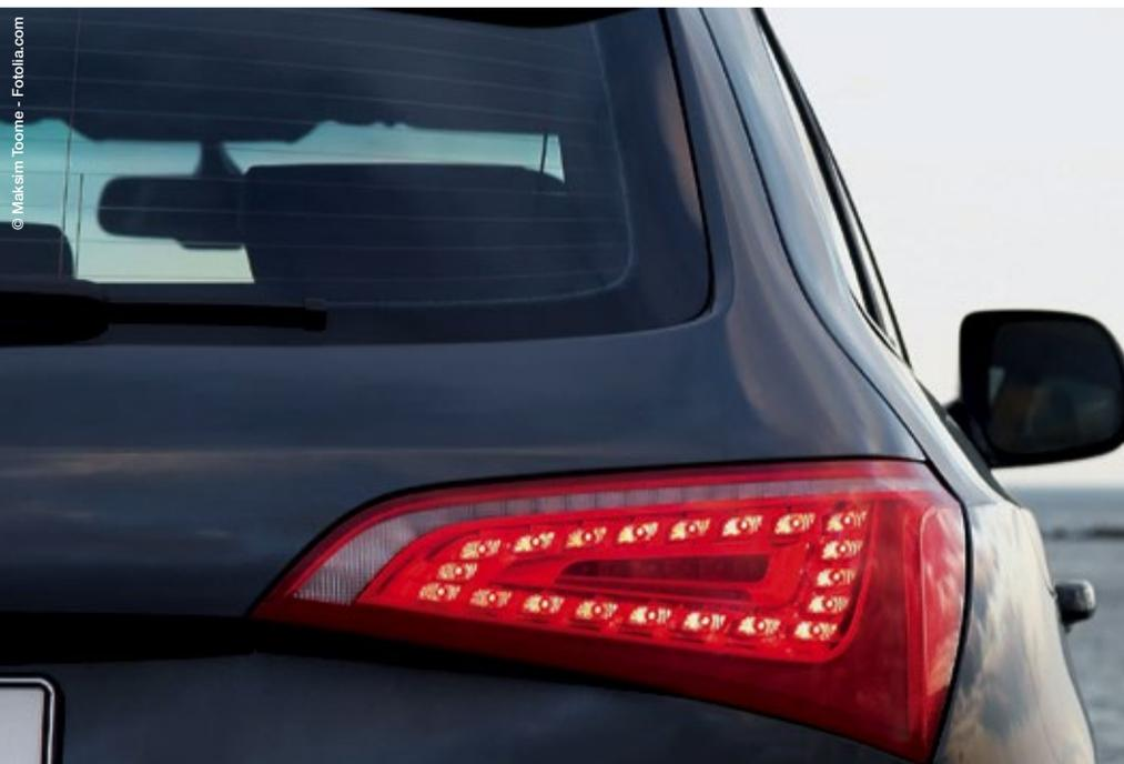
LED-Leuchtmittel sind aufgrund ihrer Bauweise, ihres Wirkungsgrades, ihrer Schaltfestigkeit und langen Lebenserwartung häufig in Signaleinrichtungen und Automobilen verbaut. Um einen optimalen Betrieb, eine lange Lebensdauer und eine gleichmäßige Lichtausbeute zu gewährleisten, müssen sie mit einem konstanten Strom betrieben werden. Gleichzeitig ist wichtig, dass der maximal zulässige Betriebsstrom der LEDs nicht überschritten wird.
