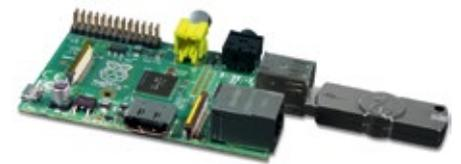
Raspberry Pi mit aufgesteckter Schutzhardware CmStick
