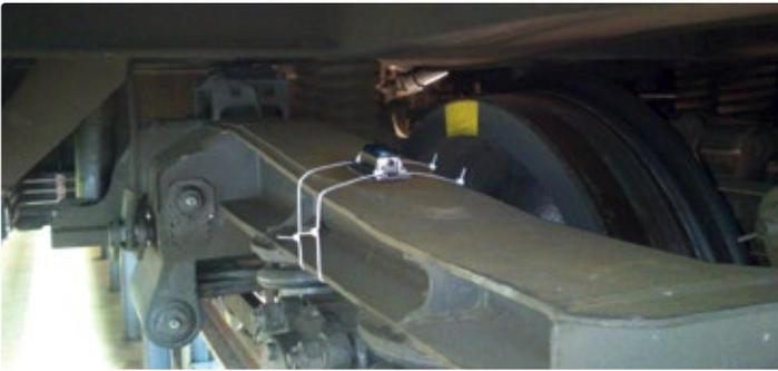
Um die Fahrstabilität von Schienenfahrzeugen nachzuweisen, wird in Testfahrten die Beschleunigung in Querrichtung des Fahrwerkrahmens erfasst. Dazu wird ein MSR-Mini-Datenlogger am Rahmen befestigt.
