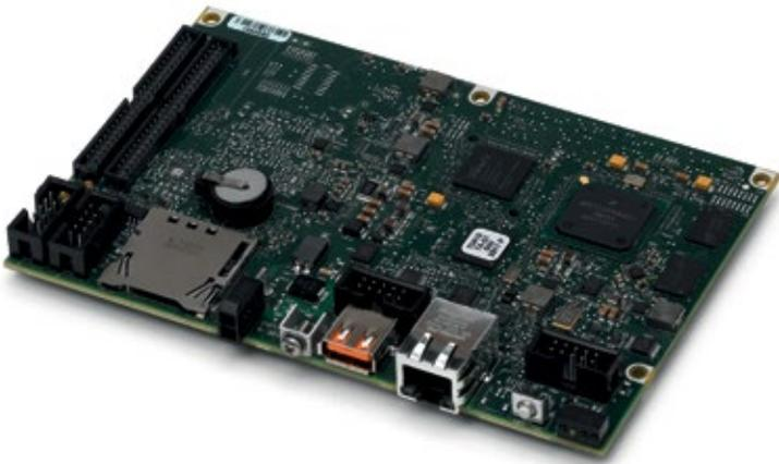
Das in das Embedded-System sbRio-9633 integrierte FPGA übernimmt die analoge und digitale Datenerfassung bei extrem unterschiedlichen Datenraten.
