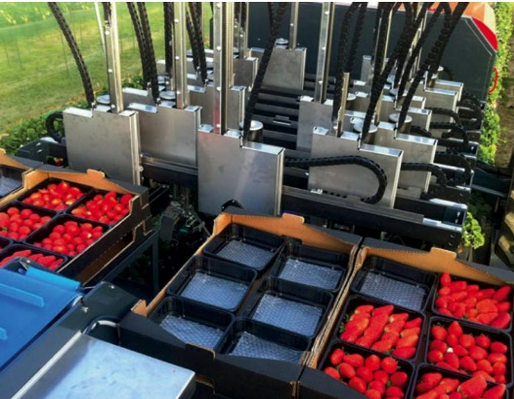
Das Förderband transportiert die automatisch geernteten Früchte vom Roboterarm zum Verpackungsbereich, wo sie von einem Erntemitarbeiter in handelsübliche Schalen sortiert werden.
