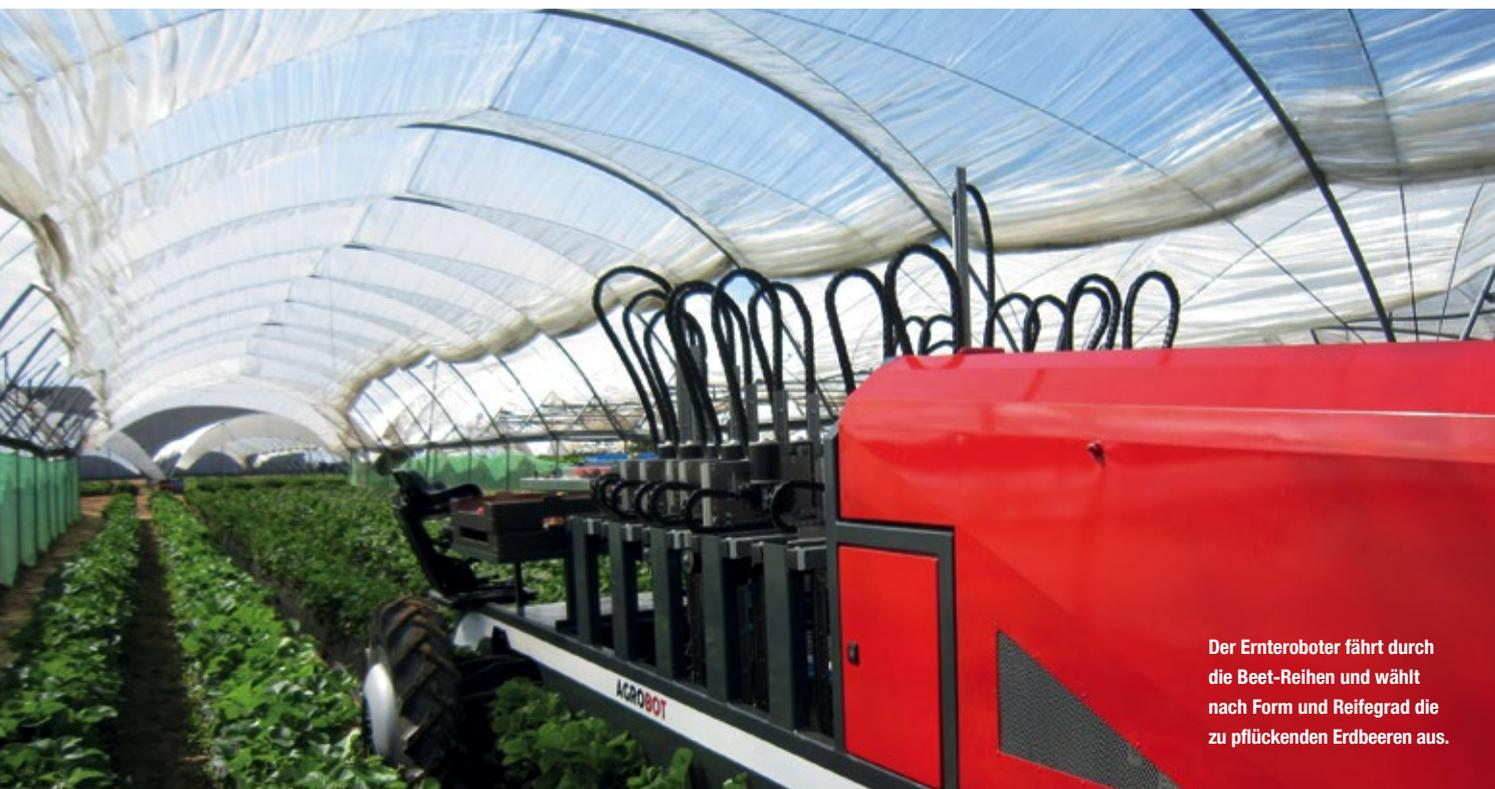
Der Ernteroboter fährt durch die Beet-Reihen und wählt nach Form und Reifegrad die zu pflückenden Erdbeeren aus.
