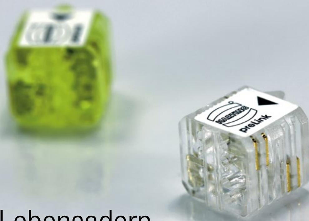
Der Harting PreLink-Abschlussblock sorgt für die schnelle und sichere Verkabelung.
