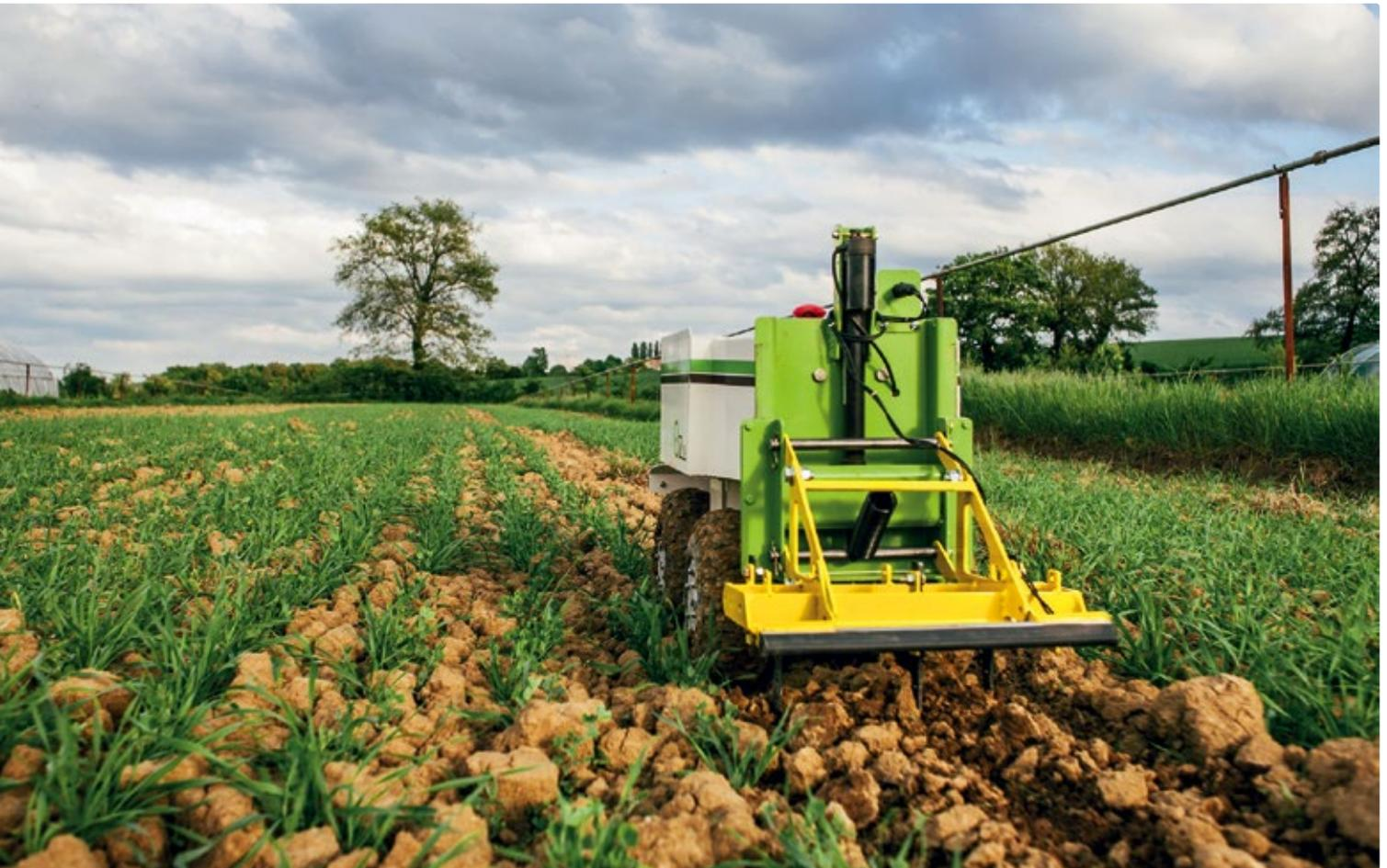
Oz, der automatische Jät-Roboter von Naïo Technologies
