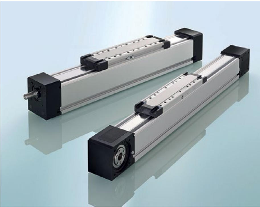
Die speziell für den Reinraum entwickelten Achsen bietet RK Rose+Krieger wahlweise mit Kugelgewindtrieb (hinten) oder Zahnriemenantrieb (vorne) an.
