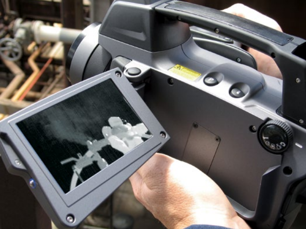
Mit der Gasdetektionskamera GF343 können CO 2 -Lecks schnell aus sicherer Entfernung lokalisiert und visualisiert werden.
