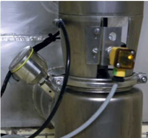
Der Leitfähigkeitssensor ICS-8 (links im Bild) eignet sich zur Phasentrennung, Produkterkennung und Messung der Medienkonzentration in CIP-Anlagen.
