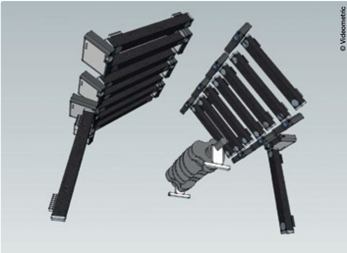
Das bildverarbeitungsgestützte System besteht aus 16 Karbonfaserarmen mit je zwei monochromen VGA-Kameras von Baumer und einem LED-Beamer.
