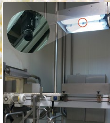
Die Basler-Scout GigE-Kamera wurde unter einer Lichtquelle über dem Förderband montiert und erfasst die Grafiken auf den Säcken mit den Zutaten.
