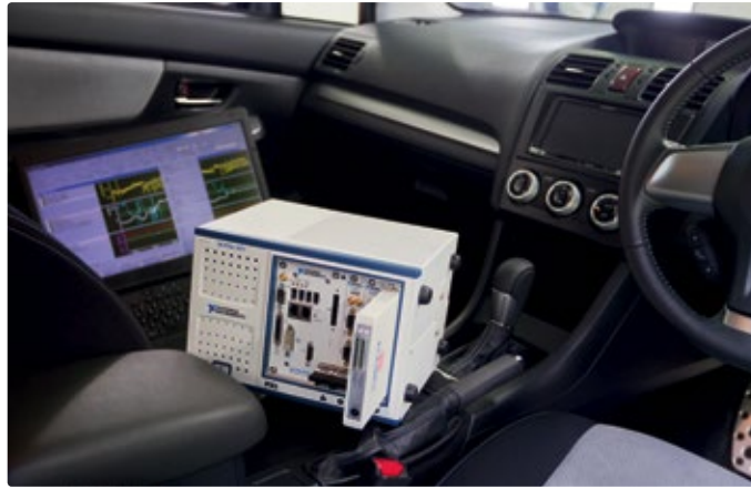
Die Hardware des HIL-Systems basiert auf der Plattform NI FlexRio. Dabei handelt es sich um PXI-basierte Controller mit FPGA-Chips. Die Module führen ein Modell aus, das den Betrieb der Motoren simuliert.
