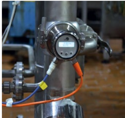
Im Gehäusedeckel des Leitfähigkeitssensors sind Display und Funktionstasten integriert, sodass er sich menügeführt parametrieren lässt.
