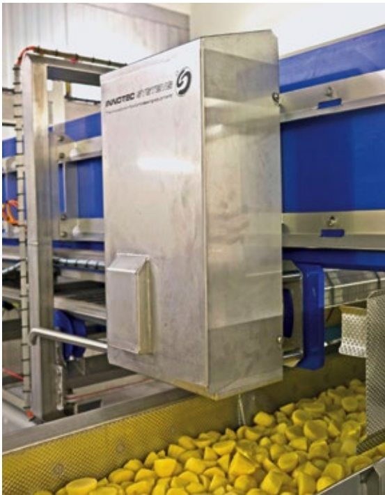
Doppelte Sicherheit: Die Edelstahlhaube deckt den kompletten Motor samt Drehgeber im Betrieb ab.
