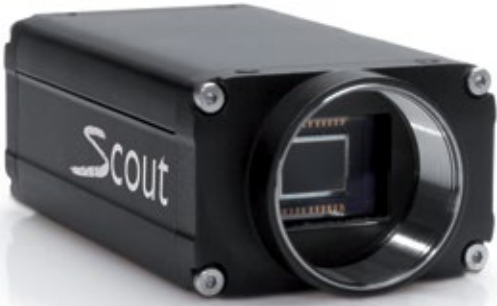
Die Basler-GigE-Kamera (scA1390-17gm) mit dem Sony ICX267-CCD-Sensor liefert bei einer Auflösung von 1,4 MP 17 Bilder pro Sekunde.
