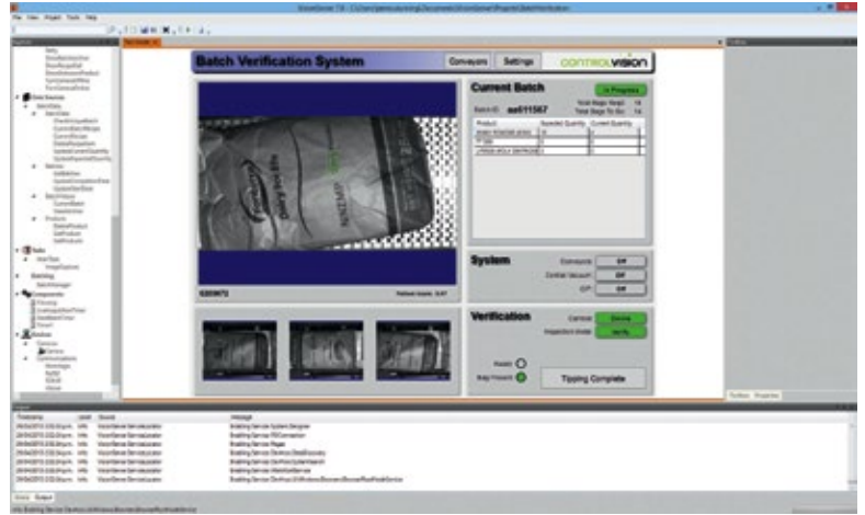
Dank der eingebetteten PatMax-Software von Cognex kann das System die grafischen Aufdrucke von mehr als 100 Säcken mit Zutaten unterscheiden und zuverlässig erkennen.
