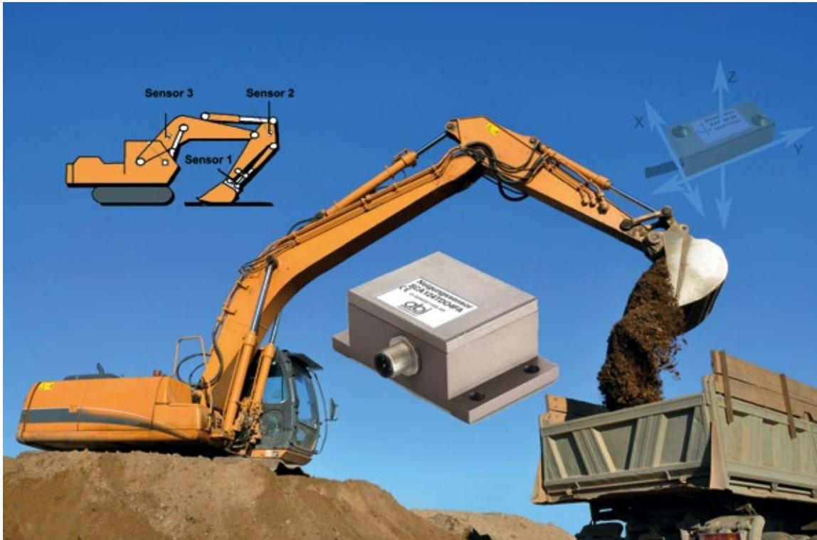
Mit der 3D-MEMS-Technologie lassen sich Neigungswinkel, Vibrationen und Wege an Baufahrzeugen messen.
