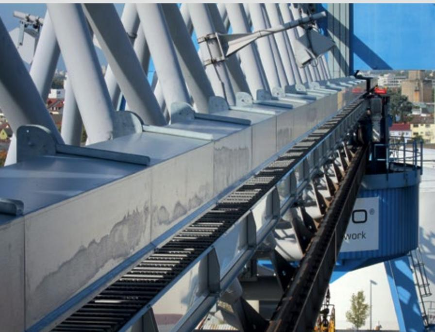
**Eine geschlossene, aber aufklappbare Dachkonstruktion bietet die gewünschte Wartungsfreundlichkeit und einen guten Schutz gegen die Elemente.**
