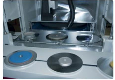
Die tellerförmigen Werkstückträger laufen bei automatischer Serienkennzeichnung auf der Curviline-Führung in die Anlage.
