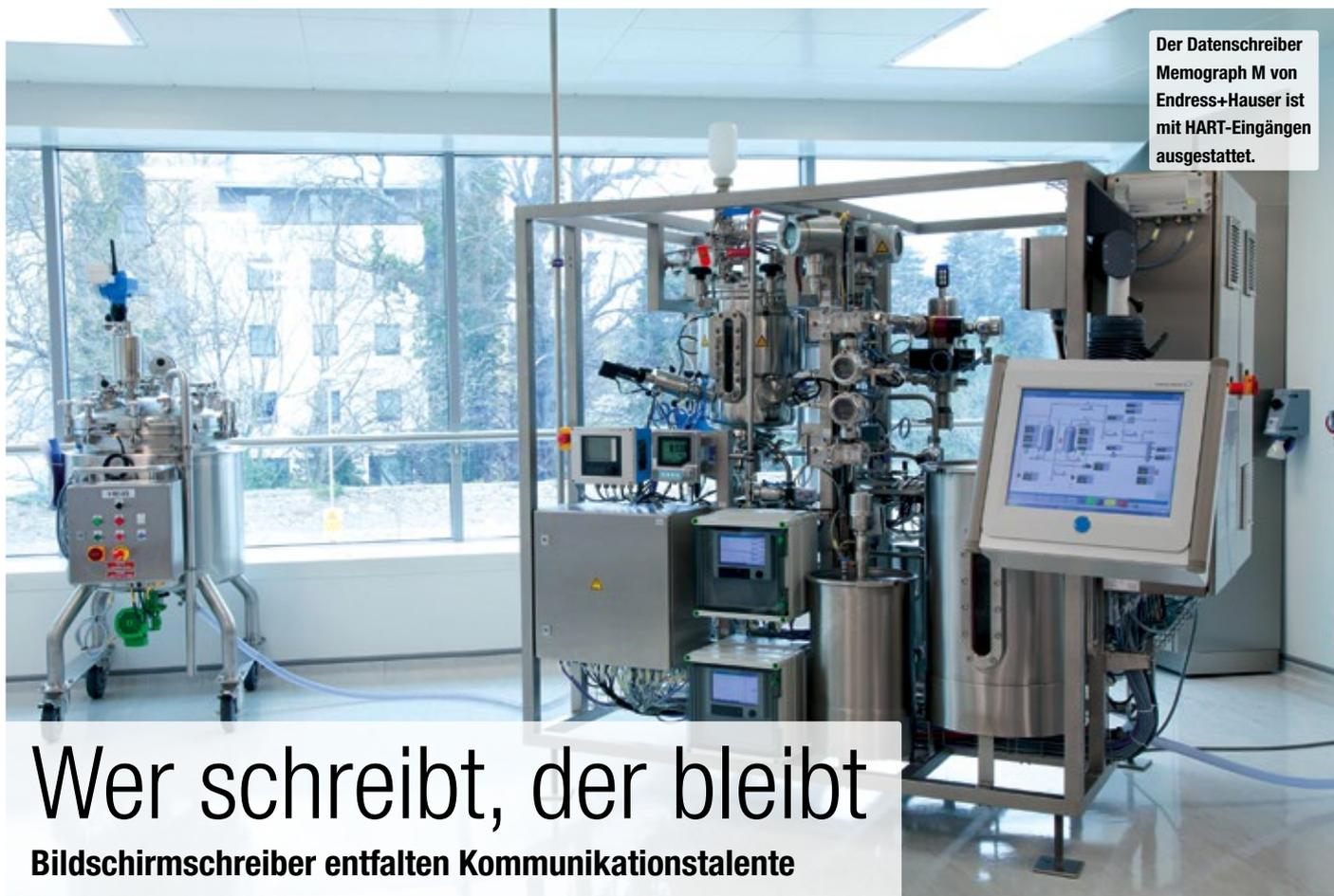
**Der Datensreiber Memograph M von Endress+Hauser ist mit HART-Eingängen ausgestattet.**
