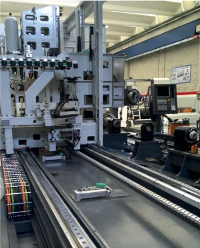
**Linearachse mit Kugelgewindetrieb von Kammerer in einer Portalfräsmaschine Leonard LT4.60 von Rema Control**
