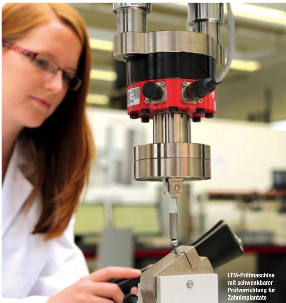
LTM-Prüfmaschine mit schwenkbarer Prüfvorrichtung für Zahnimplantate
