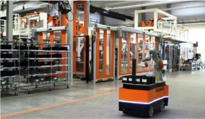
In regelmäßigen Abständen prüft der KMR iiwa sensitiv die einzelnen Regale ab und entnimmt die angelieferten, mit den Kleinteilen bestückten Boxen.
