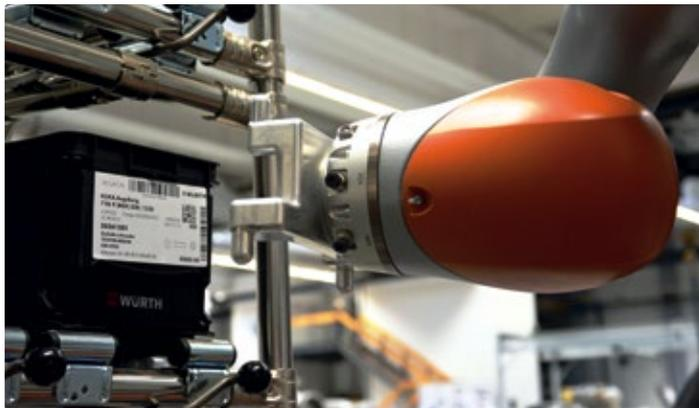
Der KMR iiwa beliefert automatisch den Roboterarbeitsplatz in der KR Quantec Zentralhandmontage mit Produktionsmaterial.
