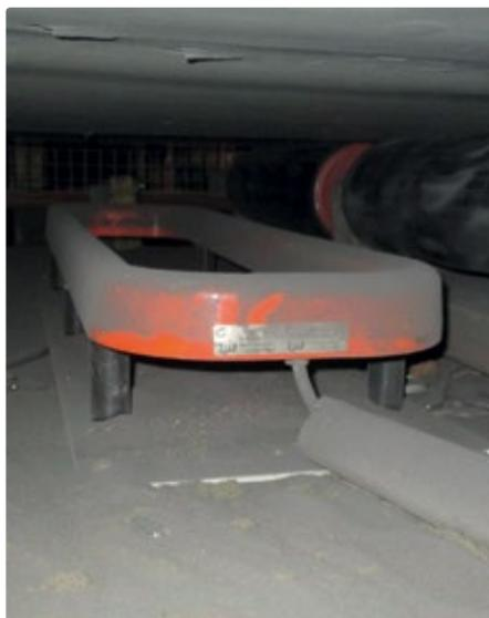
Die Detektorspule unter dem Förderband ist mit PVC-Säulen auf einer Aluminiumgrundplatte montiert, die gegen elektromagnetische Störungen der Unterbaukonstruktion abschirmt. Dieses Konzept gewährleistet außerdem eine sehr stabile Montage.
