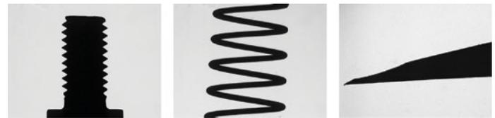
**Form- und Maßhaltigkeitsprüfung mittels telezentrischer Abbildung: Winkelmessung von Schraubengewinde, Steigungsprüfung an Schraubenfedern und Formkontrolle von Injektionsnadeln.**
