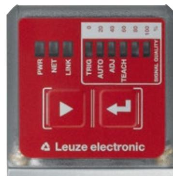
Der Codeleser wird über zwei Tasten am Gerät und der passenden App auf dem Smartphone parametrierbar.
