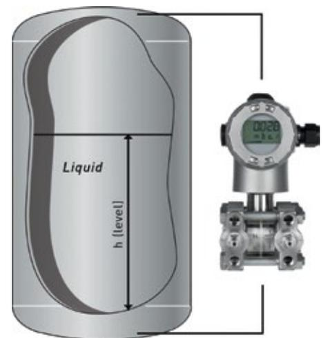
Prinzip der Füllstandmessung in geschlossenen Tanks mit dem Jumo dTrans p20 Delta Differenzdruckmessumformer mit Druckmittler
