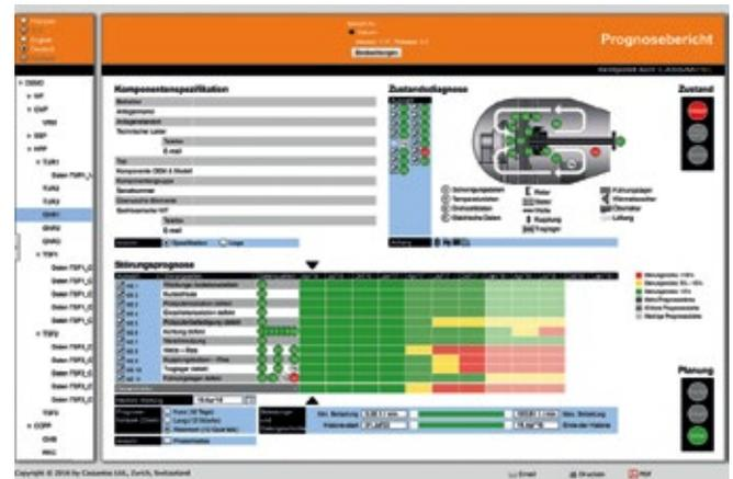
Durch die Darstellung in Form einer Ampel kann der Benutzer auf einen Blick erkennen, in welchem Zustand sich die Anlagenkomponenten aktuell befinden.
