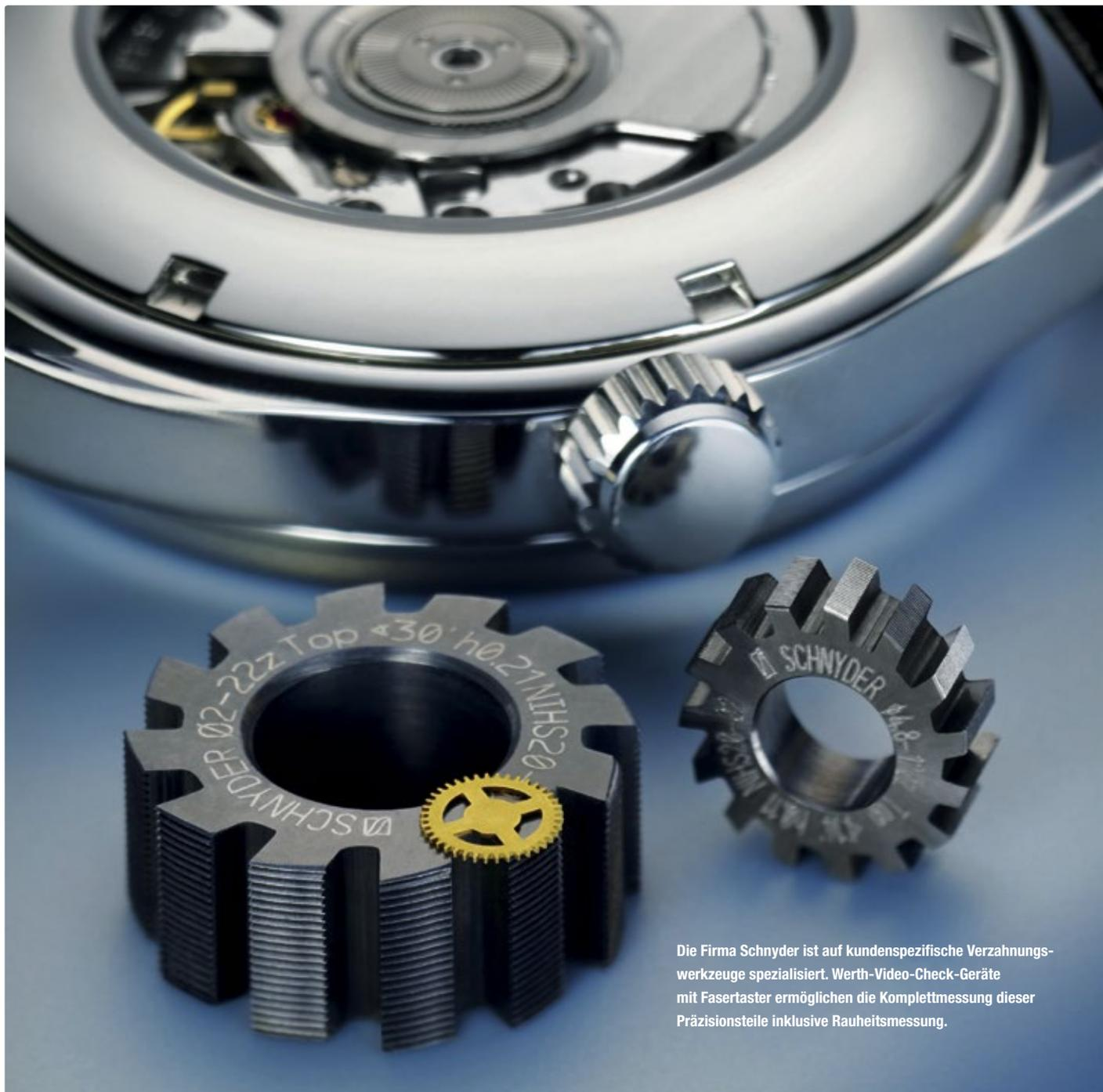
Die Firma Schnyder ist auf kundenspezifische Verzahnungswerkzeuge spezialisiert. Werth-Video-Check-Geräte mit Fasertaster ermöglichen die Komplettmessung dieser Präzisionsteile inklusive Rauheitsmessung.
