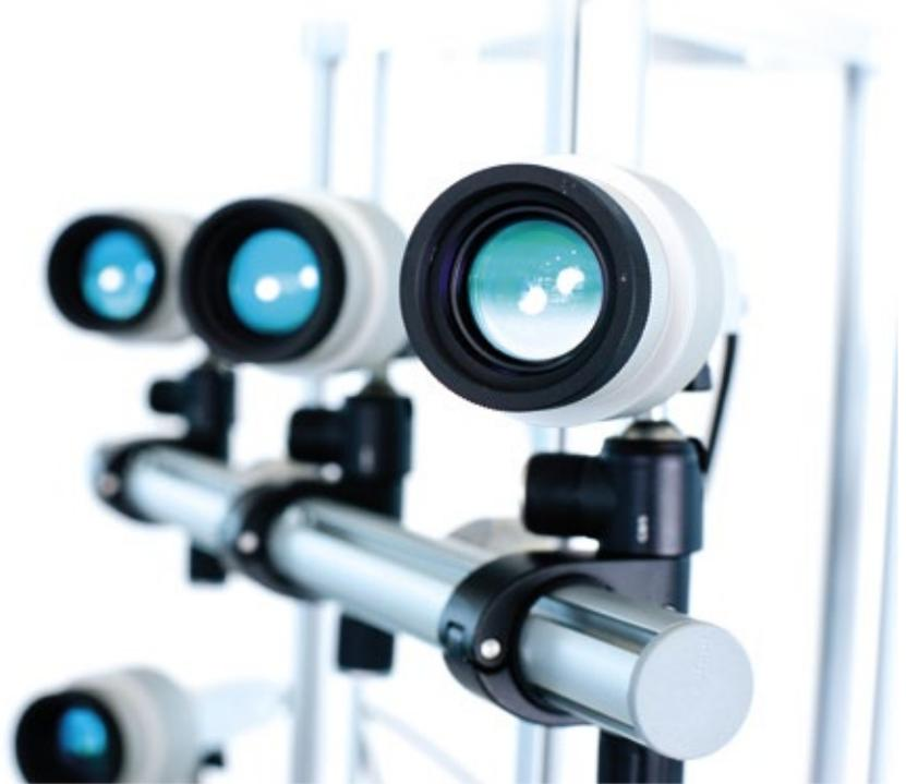
Die flexible Multisensorik ermöglicht eine individuelle Anordnung der Messpunkte zur berührungslosen Schwingungsanalyse dynamischer, instationärer Vorgänge.
