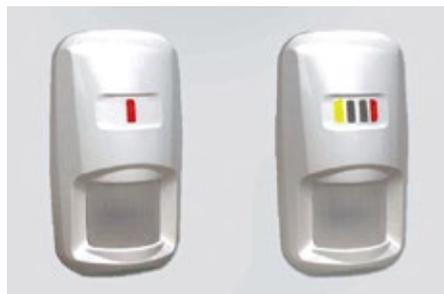
an Zuverlässigkeit. Das in beiden Bus-Meldern verwendete Duo-Detektionsprinzip erfasst die Signale über zwei unabhängige Sensoren. Erst wenn die digitale Signalverarbeitung von beiden Sensoren in einem bestimmten Zeitfenster definierte Werte erhält, wird Alarm ausgelöst. Durch die Doppel-Sensor-Technologie werden Falschalarm-Kriterien bereits im Vorfeld zuverlässig ausgefiltert.
