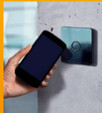
per NFC mit dem Android-Smartphone auf Türen mit elektronischem Schließsystem oder Mitarbeiterausweise übertragen. Mit der Kombination aus App und Hardware lassen sich bis zu 25 Türen sowie 250 Anwender kostenschonend verwalten, ohne dass dafür ein komplexes Zutrittssystem aufgebaut werden muss.
