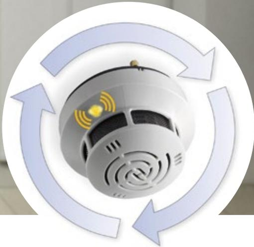
Rauchschalter ohne Verschmutzungskompensation müssen nach fünf Jahren ausgetauscht werden. Für Rauchschalter mit Verschmutzungskompensation, wie dem ORS 142 von Hekatron, gilt eine Austauschfrist von acht Jahren ▼
