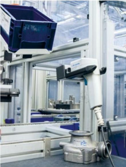
◀ Jedes Bauteil des Turboladers ist mit einem individuellen DataMatrix-Code versehen. Mit einem an der Montagezelle angebrachten kabelgebundenen Handlesegerät erfasst der Arbeiter das jeweils zu montierende Laderelement.
