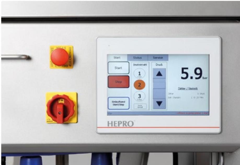
Das WWPEC100 ist speziell für kleine und mittlere Bedien- und Beobachtungsaufgaben konzipiert. Das Gerät ist mit dem MicroBrowser ausgestattet und somit prädestiniert für Codesys-Web-Visualisierung V2 und V3.
