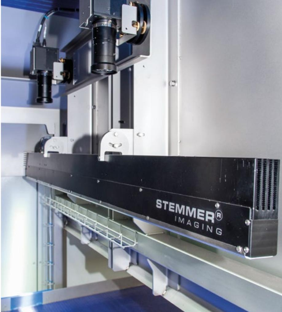
Die Brote werden unter einer Zeilenbeleuchtung und einer Zeilenkamera hindurch befördert und dabei – je nach Breite des Transportbands – von ein oder zwei Zeilenkameras inspiziert.
