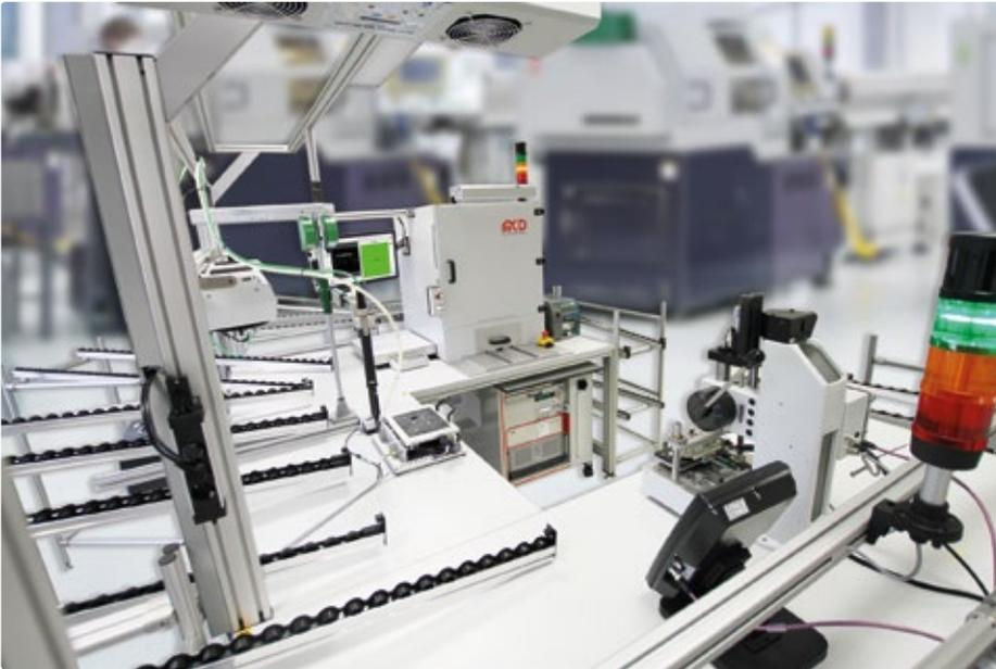
Im Vordergrund rechts, die Handpresse für die Montage der Panels, in der Mitte die Station für die Endmontage des Steuergeräts, im Hintergrund die Prüfstelle für die optische und elektrische Prüfung.
