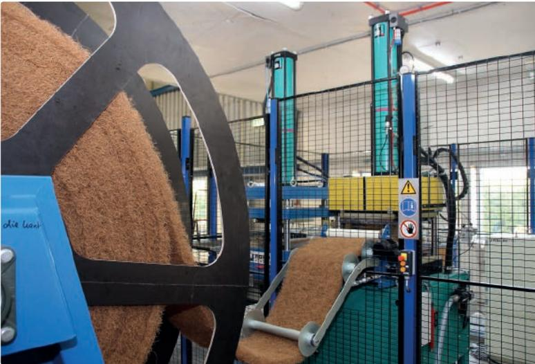
Die Abbildung zeigt die Zuführung der aus Naturfaser-Strängen konfektionierten Matte, die ab Coil der Roboter-Fertigungszelle – und hier der Formpresse mit dem beheizten Formwerkzeug – zugeführt wird.
