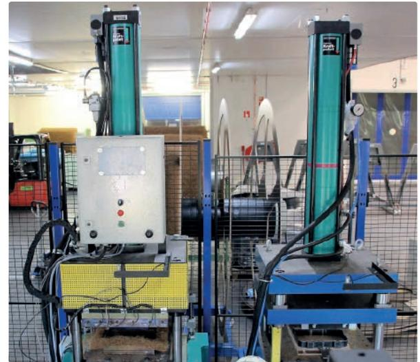
Tox-Presse vom Typ MAG mit dem Tox-Kraftpaket zum Formpressen der Rohteile (l.) und die mit einem pneumohydraulischen Tox-Kraftpaket-Antriebszylinder ausgerüstete Besäum- und Stanzstation (r.)
