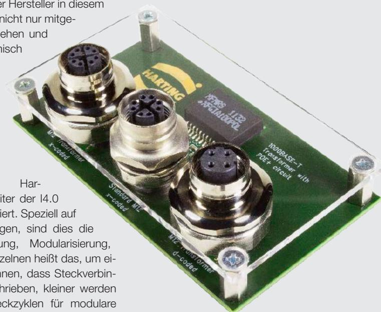
Abb. 2: Demonstrator mit bisheriger Lösung und neuem M12-Transformer
