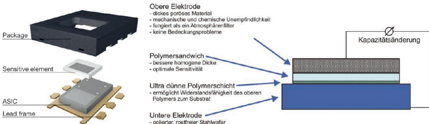
**Aufbau des HTU21X und Aufbau einer kapazitiven Feuchtemesszelle auf Polymerbasis (r.)**
