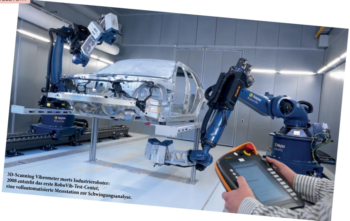
3D-Scanning Vibrometer meets Industrieroboter:
