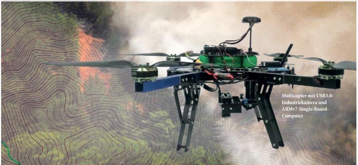
Multicopter mit USB3.0-Industriekamera und ARMv7-Single-Board-Computer
