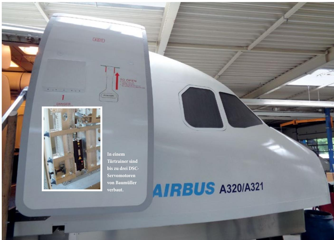
In einem Türtrainer sind bis zu drei DSC-Servomotoren von Baumüller verbaut.
