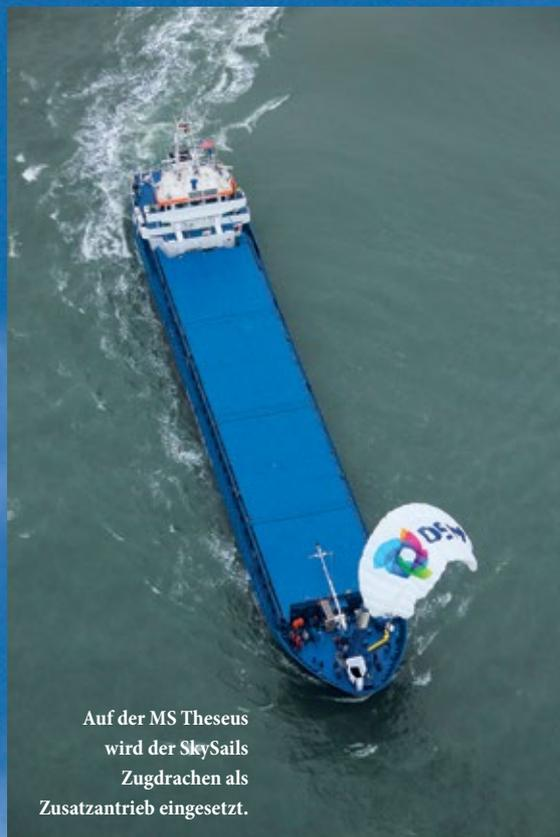
Auf der MS Theseus wird der SkySails Zugdrachen als Zusatzantrieb eingesetzt.
