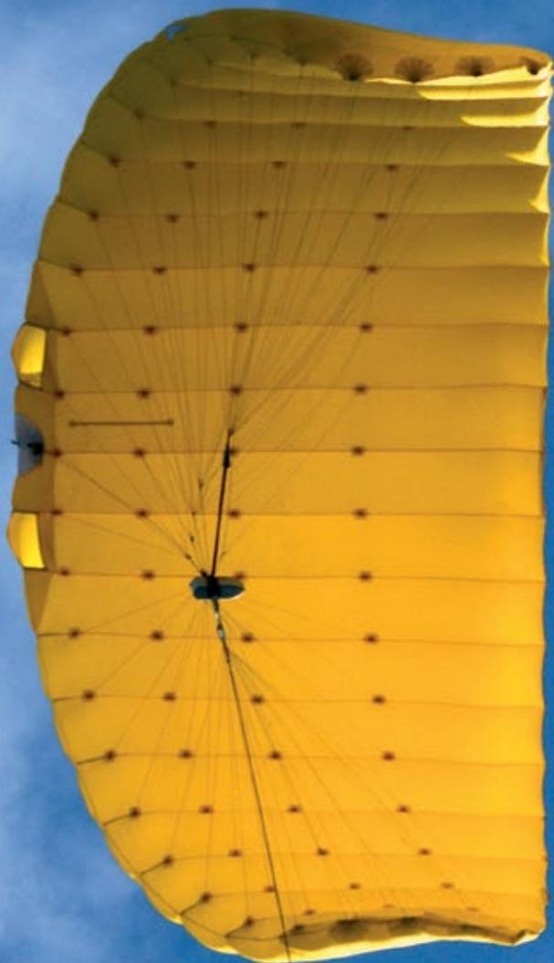
Der Treibstoffverbrauch großer Schiffe ist alles andere als ökonomisch. Was liegt also näher, als diesen mittels alternativer Antriebsarten zu reduzieren. 2001 nahm eine entsprechende Idee Form an: Schiffe sollten durch riesige Zugdrachen in ihrem Antrieb unterstützt werden und damit im Jahresmittel zwischen 10 und 30 Prozent Treibstoff einsparen.
