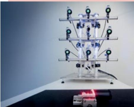
nacheinander zu messen. Die optische Multisensorik arbeitet mit bis zu 48 individuell einstellbaren faseroptischen Sensoren und erlaubt flexible Messungen, sowohl parallel auf eine Fläche als auch um komplex geformte Objekte herum.
