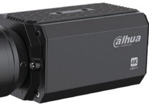
Die 4K-Ultra-HD-Lösung von Dahua überträgt ein 4K-Videosignal über bis zu 700 Meter
